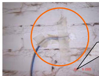
Figura 3.9 - Pasta térmica na ponta do termopar
