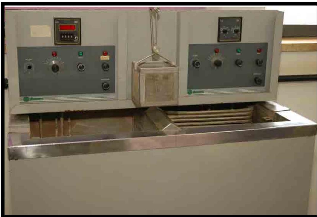
FIGURA 12 – Aparelho de ciclagem térmica.
