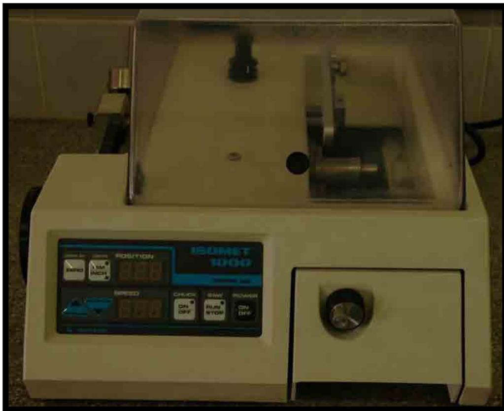
FIGURA 13 – Máquina de Corte Isomet.
