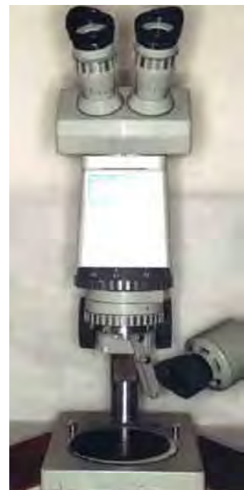
FIGURA 2 – Lupa estereoscópica JENA CARL-ZEISS.
