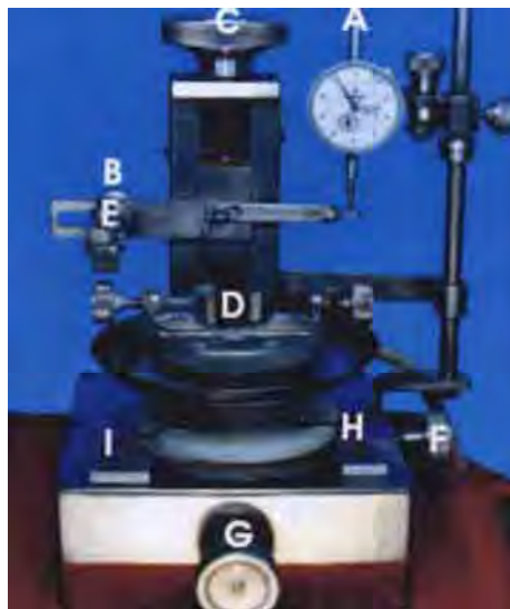
FIGURA 3 – Aparelho modificado por Sá e Gabrielli, para padronização de preparos.
