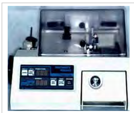
FIGURA 33 – Máquina de corte ISOMET 1000.
