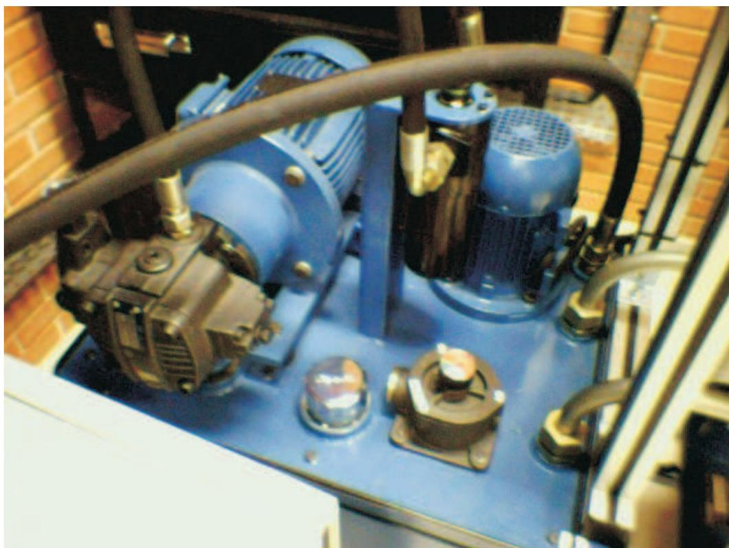
Figura 7: Unidade hidráulica.
