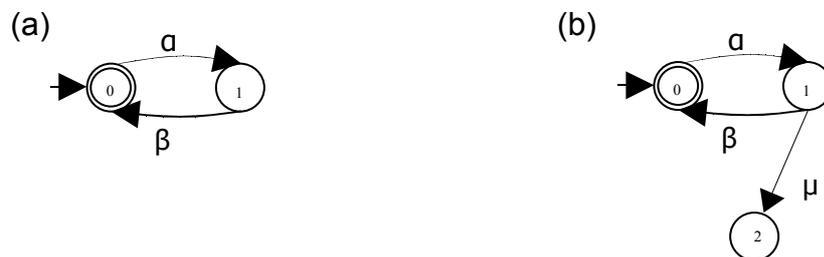
**Figura 2.2** (a) Autômato co-acessível; (b) Autômato não co-acessível com bloqueio.
