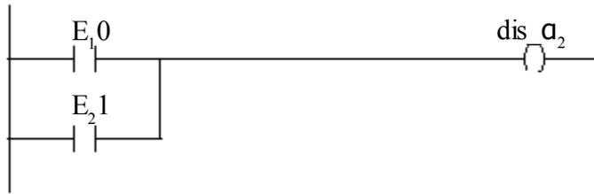
**Figura 2.11** Estrutura para sinais de desabilitação.
