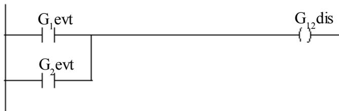
**Figura 2.12** Estrutura para sinais de desabilitação de evolução de módulos.
