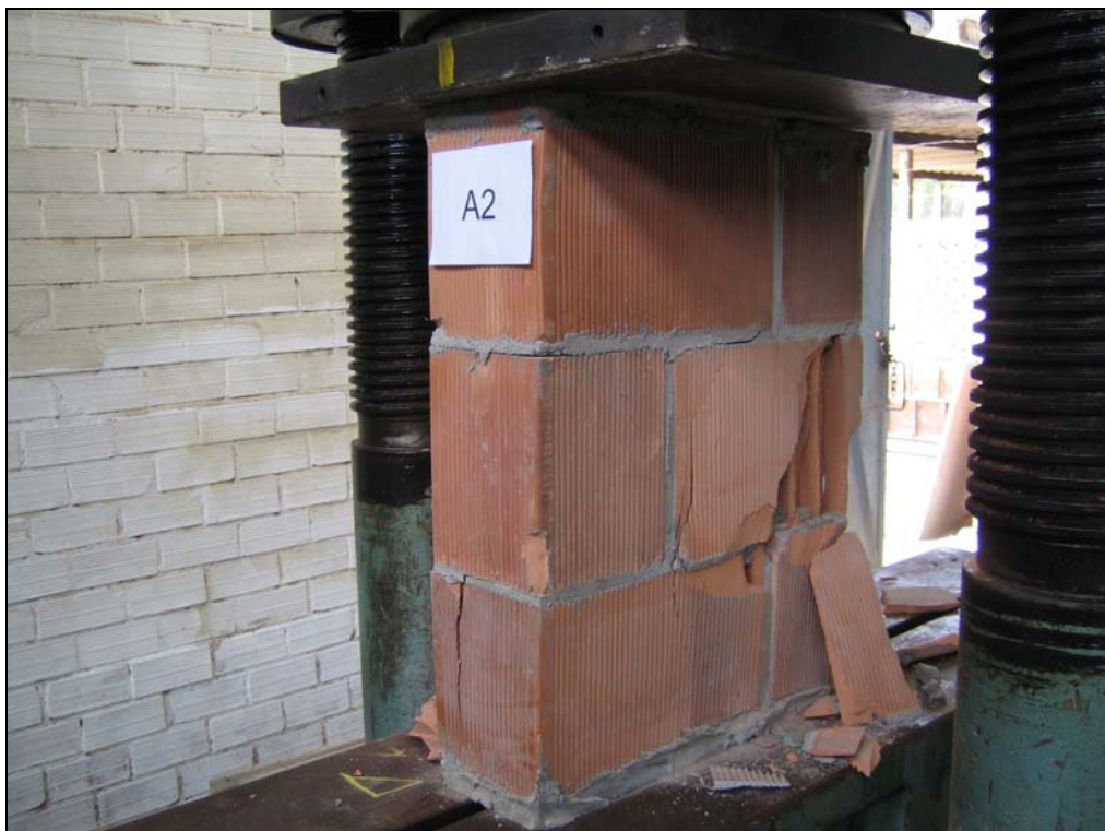
Figura 3.13 – Prisma na prensa, após rompimento.
