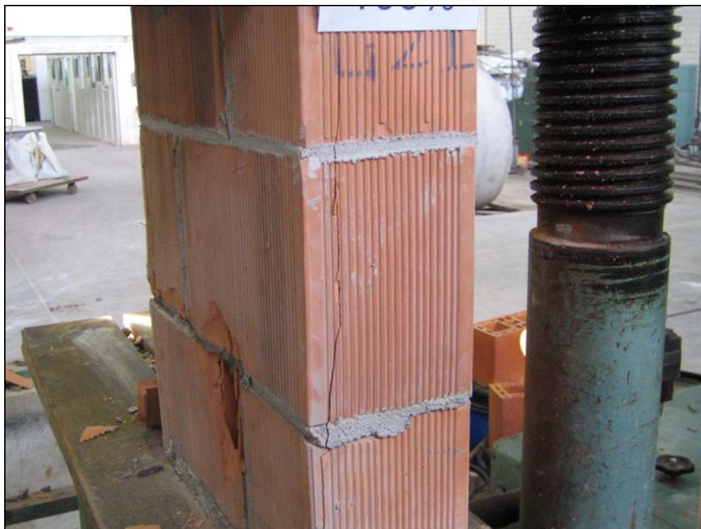
Figura 4.18 – Fissura vertical, prisma 100% grauteado.
