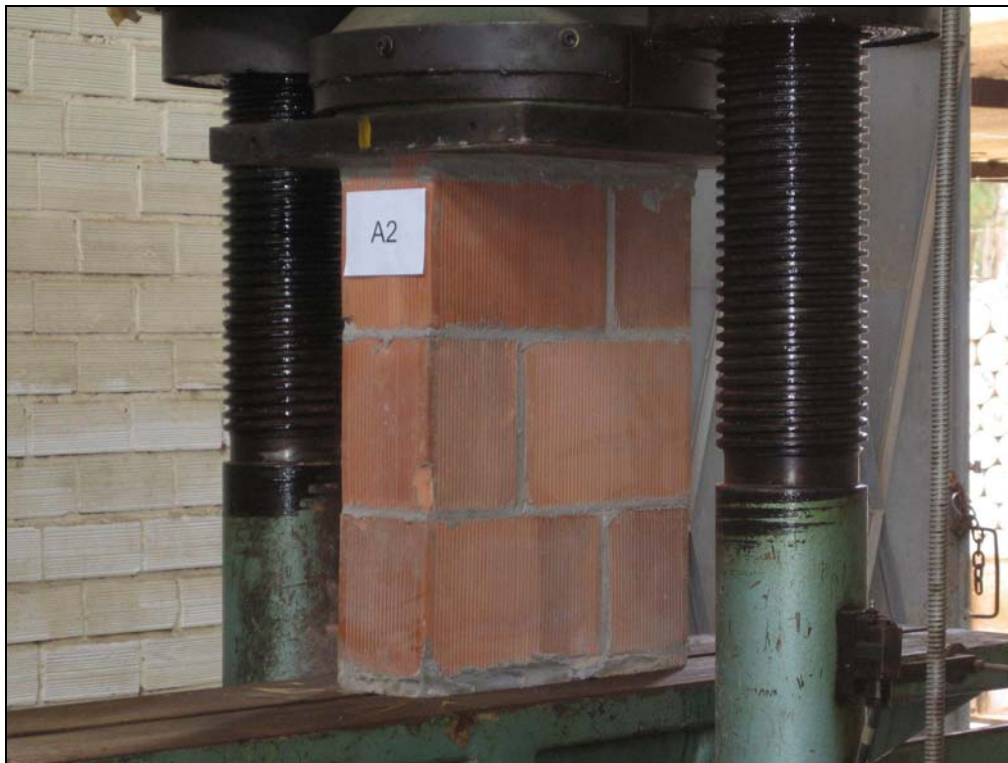
Figura 3.12 – Prisma na prensa para ensaio.
