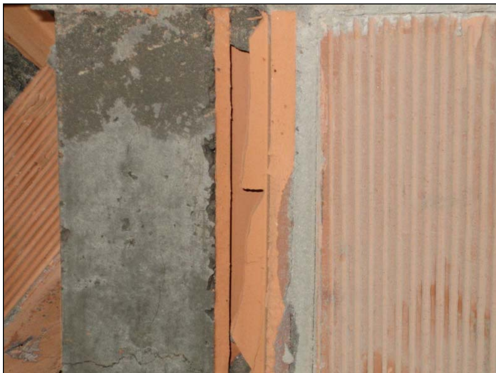
Figura 4.24 – Detalhe da interface bloco/graute.
