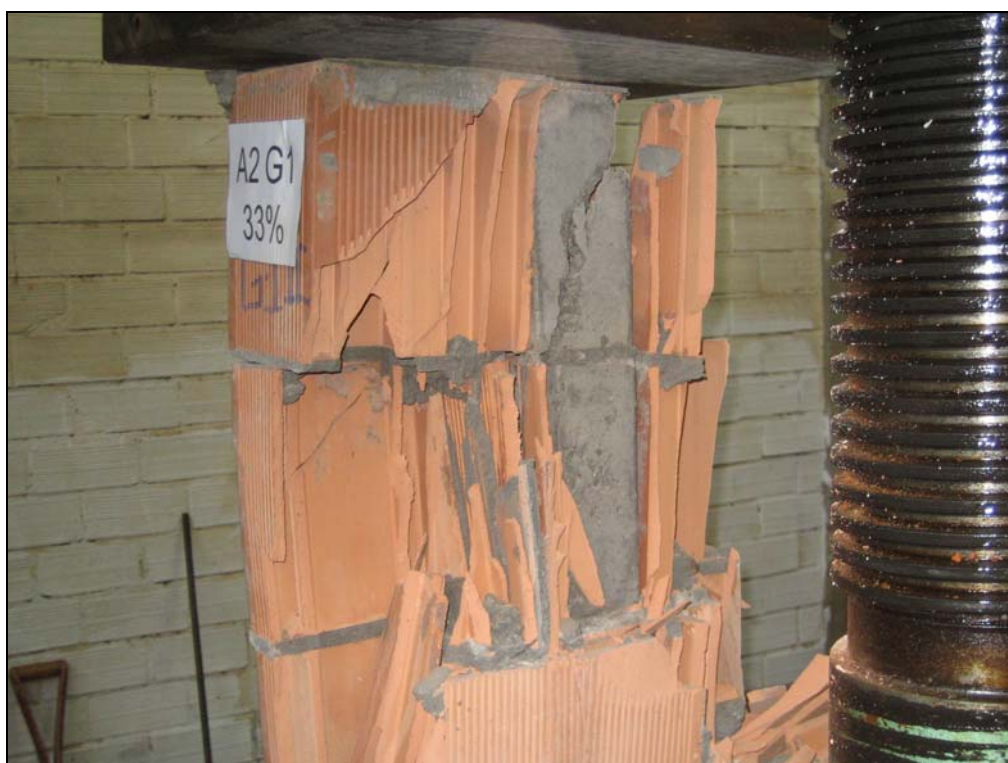
Figura 4.23 – Ruptura de prisma com graute fraco, ruptura do graute.
