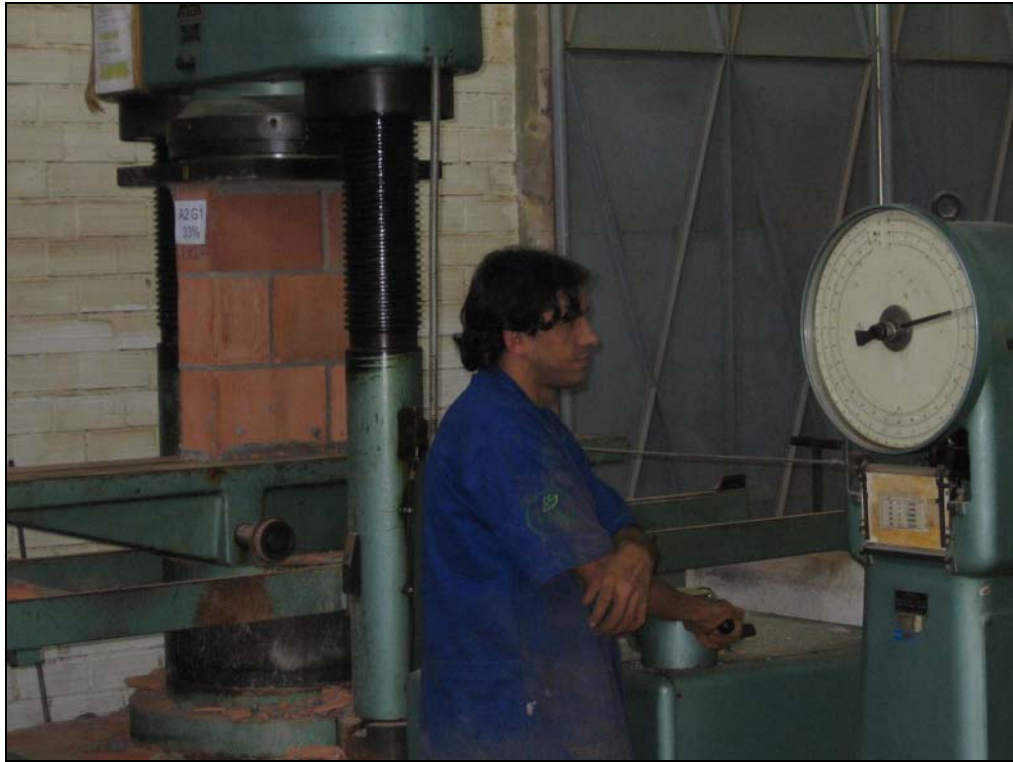
Figura 3.10 – Prensa hidráulica utilizada nos ensaios.
