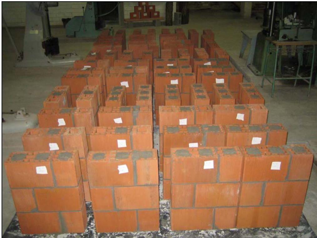
Figura 3.09 – Série de prismas após grauteamento.
