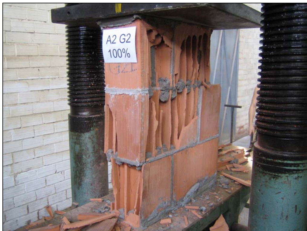
Figura 4.16 – Ruptura explosiva do prisma, argamassa A2.
