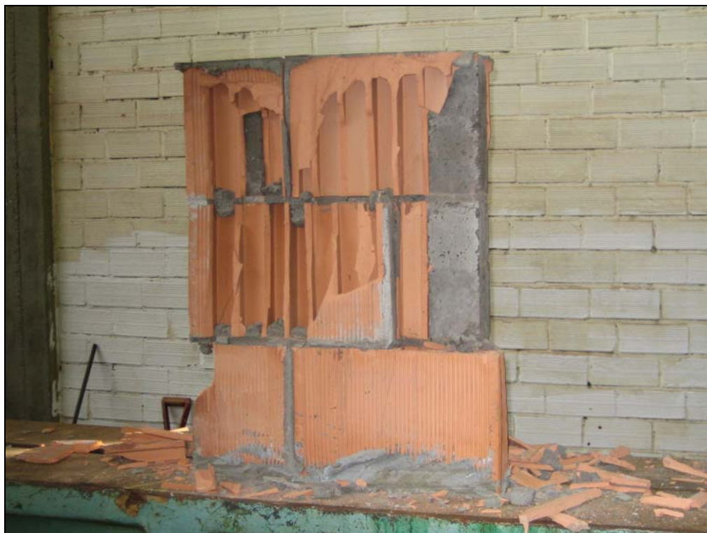
Figura 4.22 – Prisma com graute forte, formação de pilaretes.
