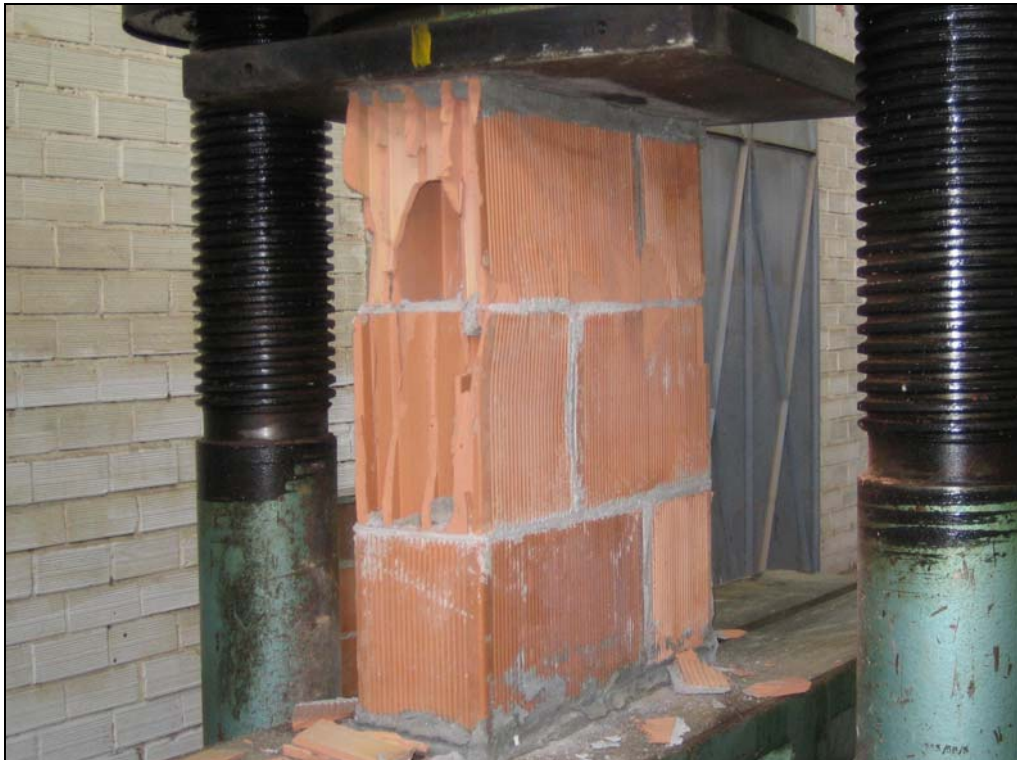
Figura 4.14 – Ruptura lenta do prisma, argamassa A1.
