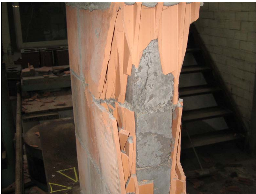
Figura 4.20 – Detalhe da ação do graute sobre o prisma.
