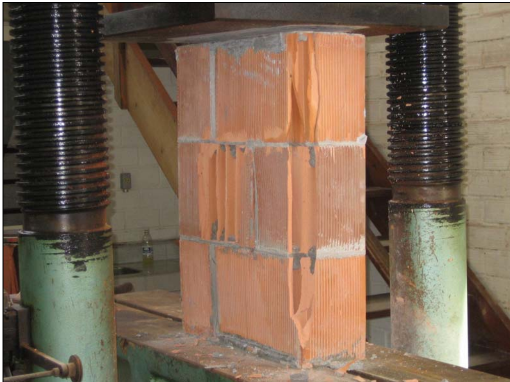
Figura 4.17 – Ruptura do prisma oco, fissura vertical.
