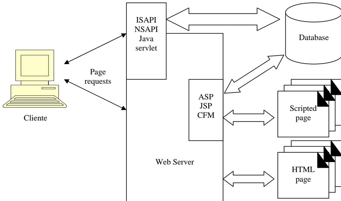
**Figura 2.4 – Relacionamento entre os componentes de um Web Server (CONALLEN, 1999)**
