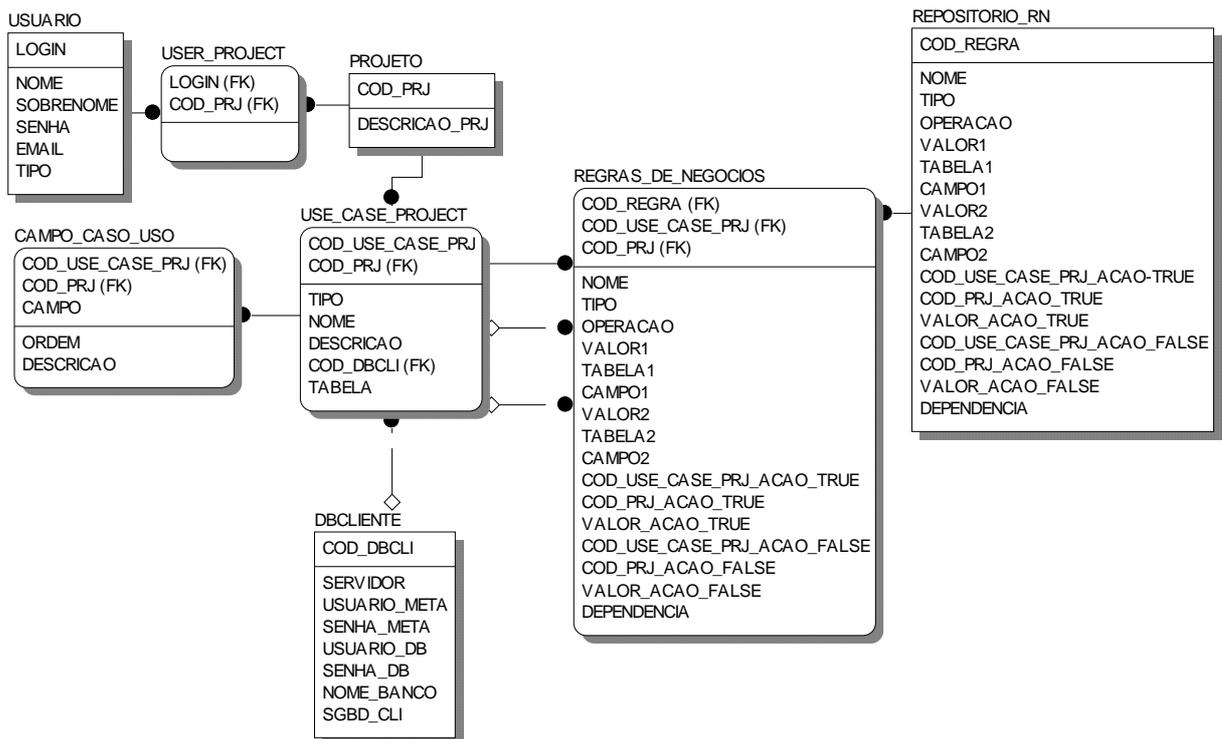
Figura 3.3 - Modelagem Entidade Relacionamento da Ferramenta BRD-Tools
