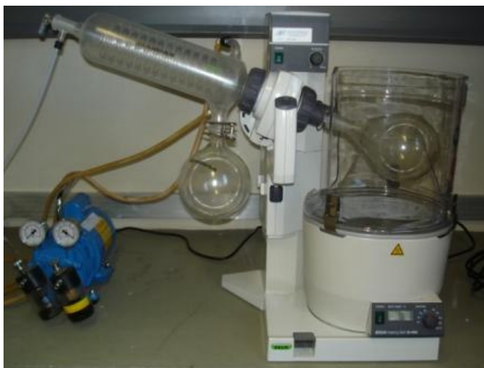
Figura 18: Rotavapor - equipamento para recuperação de asfalto
