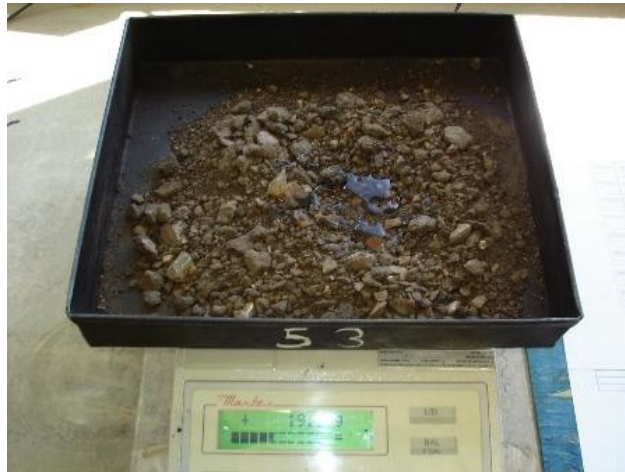
Figura 21: Adição de água antes da adição de ligante
