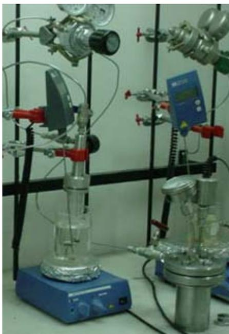
Figura 32. Foto do sistema Fischer-Porter modificado imerso em um banho de óleo silicone com o controlador digital e um reservatório de H<sub>2</sub>.
