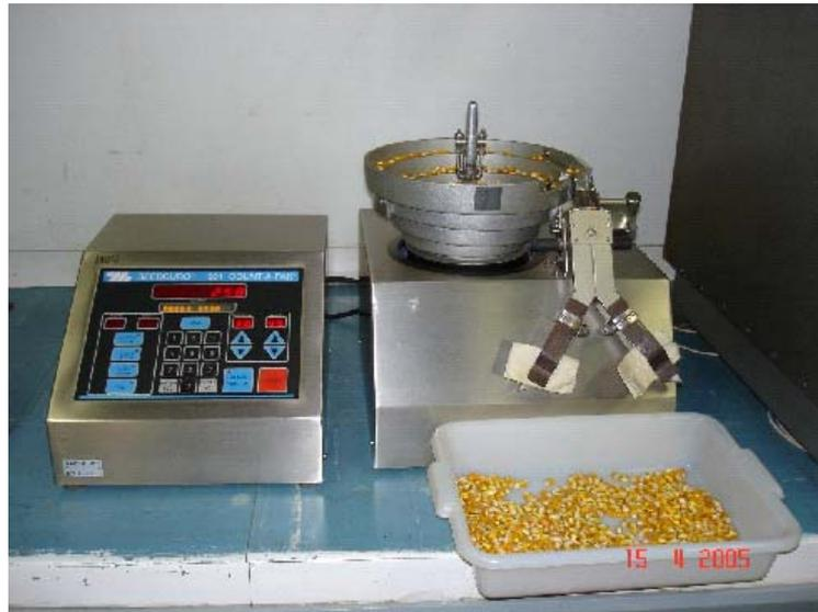
Figura 9 – Máquina contadora de grãos
