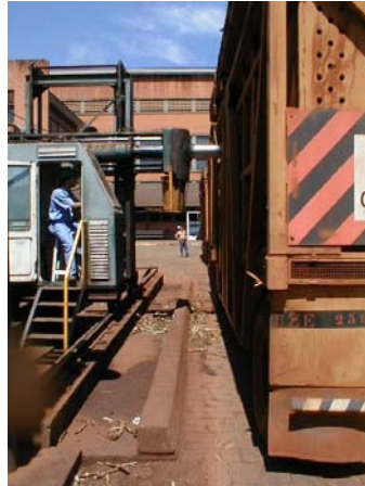
Figura 17 - Amostragem da carga pela sonda
