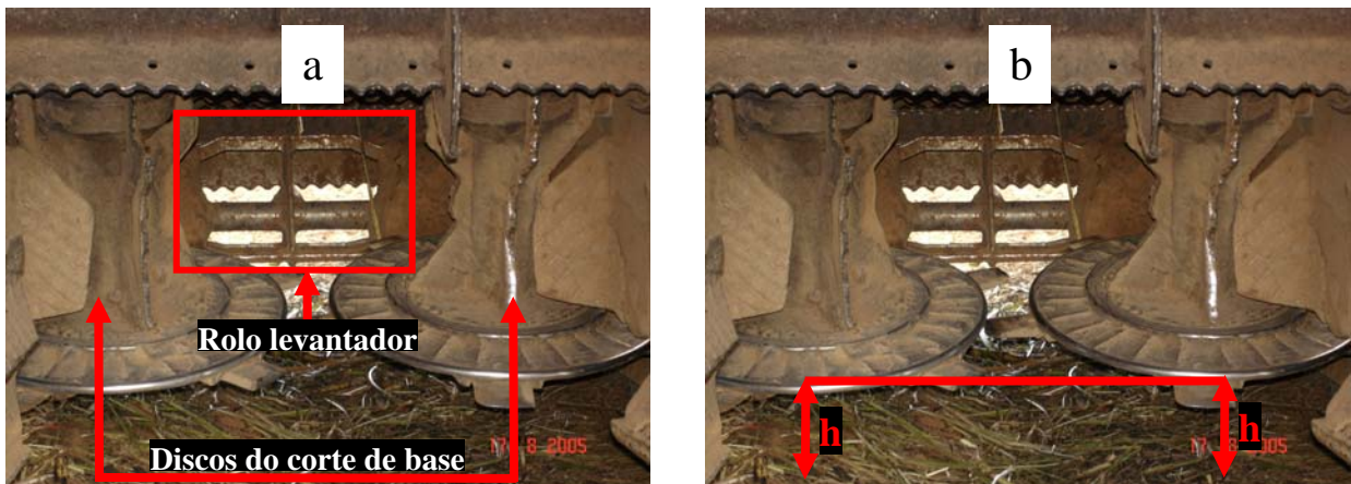
Figura 8 - Pontos de verificação de variação de pressão para controle da altura de corte do DAC (a); controle de altura, h , dos discos de corte de base (b)
