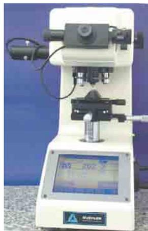
FIGURA 6 – Microdurômetro Buehler modelo 1600-6300.
