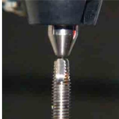
FIGURA 7 – Ensaio de dureza na base do implante.
