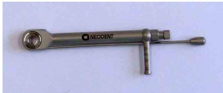
FIGURA 3 – Torquímetro protético (NEODENT – Curitiba, Brasil).
