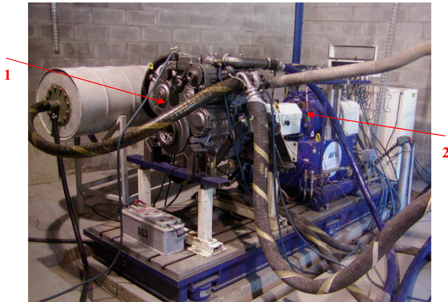
Figura 20 – Montagem do motor na bancada do dinamômetro
