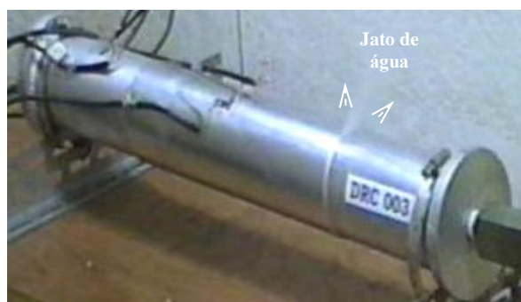
Figura 5.12 - Vazamento no espécime de uma camada no reparo.
