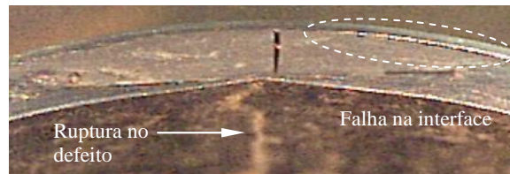
Figura 5.13 - Ruptura do espécime de uma camada.
