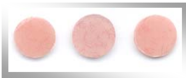
FIGURA 3 - Corpos-de-prova em resina acrílica
