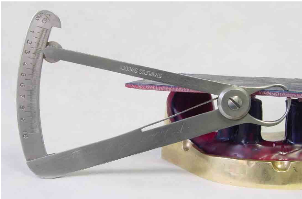
FIGURA 18 – Alívio de 2 mm em cera confirmado com espessímetro.
