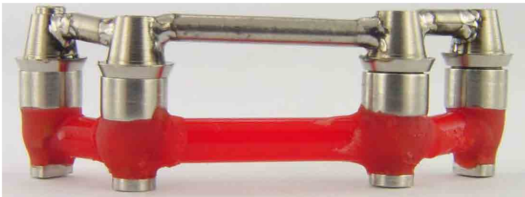
FIGURA 85 – Estrutura metálica parafusada sobre o análogo A antes do seccionamento.
