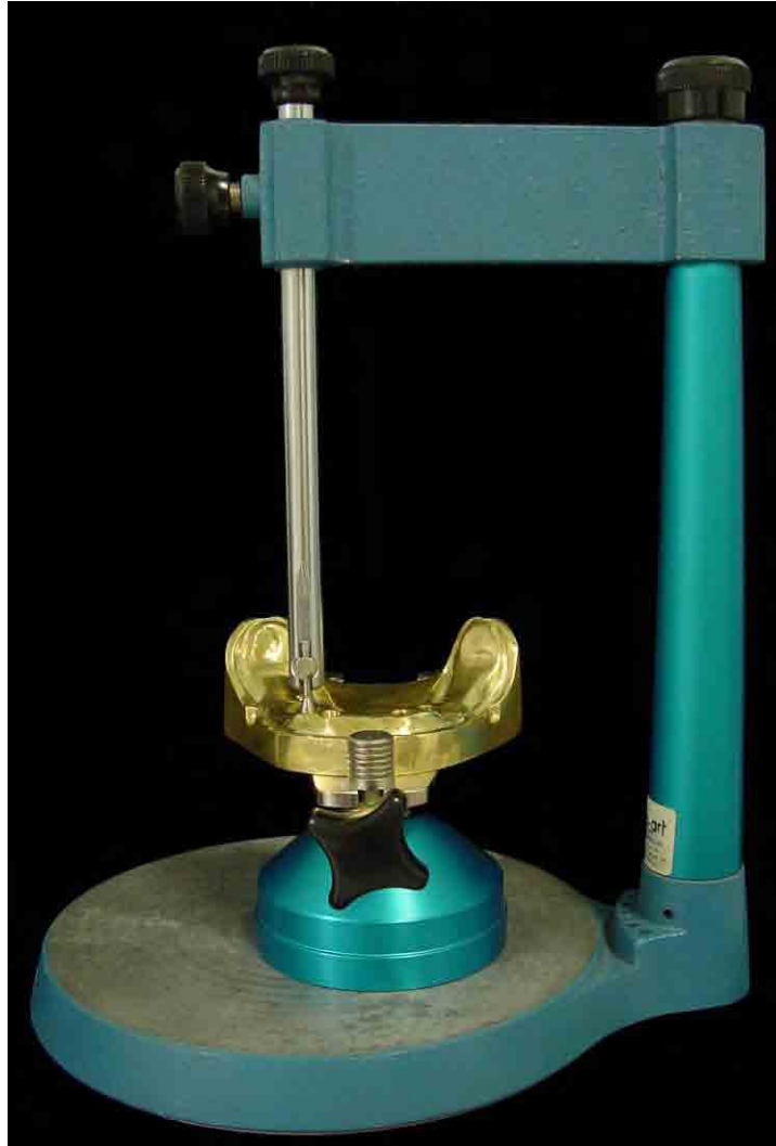
FIGURA 3 – Delineador utilizado para o posicionamento dos análogos.
