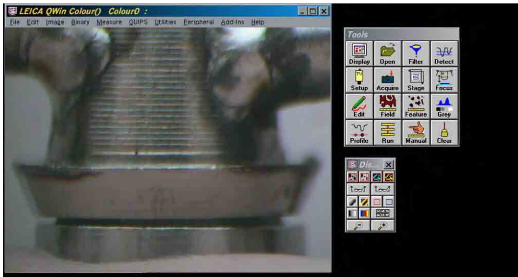
FIGURA 94 – Centralização da estrutura metálica com aumento de 16 vezes do análogo B no 1º modelo da técnica Cônico / Convencional.
