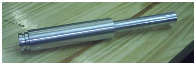
Figura 3.4 - Ponta do eixo de alumínio
