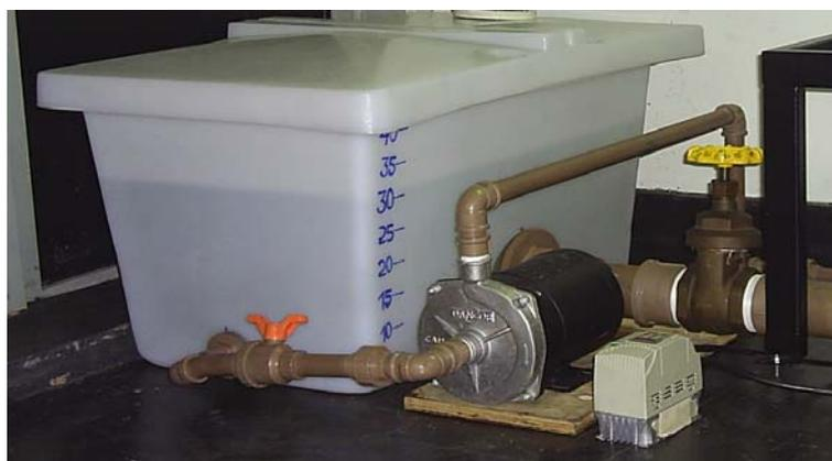
Figura 3.15 - Fotografia , tanque inferior, bomba e inversor de frequência.
