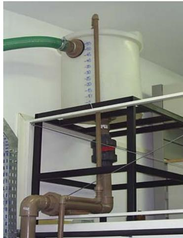
Figura 3.16 - Fotografia do tanque superior, da válvula esfera, e da mangueira de retorno.
