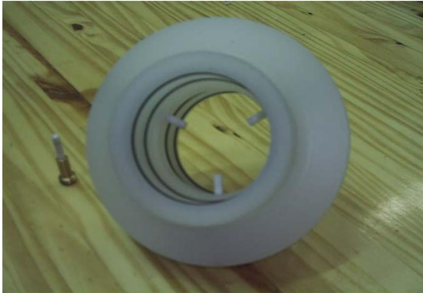
Figura 3.9 - Luva externa real (apoio eixo de acrílico) com os pinos centralizadores (apoio eixo interno de alumínio).
