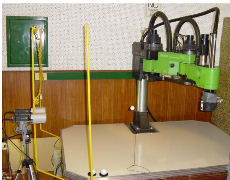
Figura 2.11 Imagem mostrando o manipulador Bosch SR-800, as duas câmaras do sistema de visão binocular e as três esferas brancas utilizadas nos experimentos.
