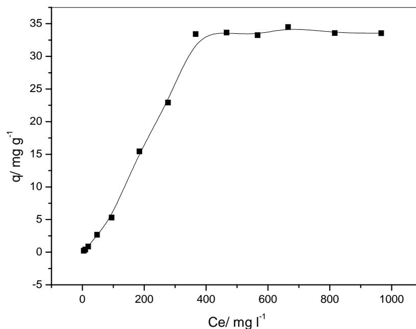
**Figura 10. Isotherma de adsorção de íons Cu<sup>2+</sup> na 4-PhAP/sílica xerogel**
