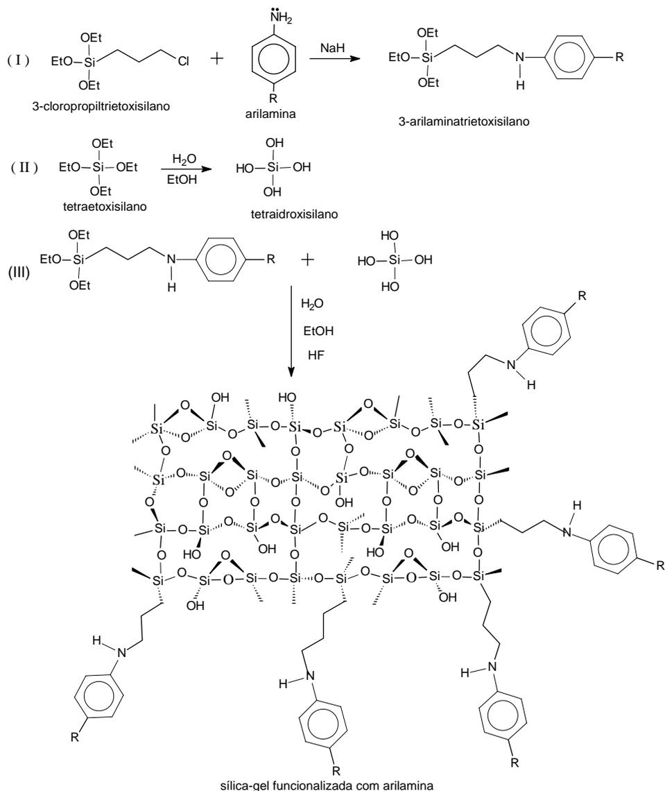
**Figura 6. Esquema representativo da síntese da sílica-gel funcionalizada com arilamina pelo processo sol-gel.**
