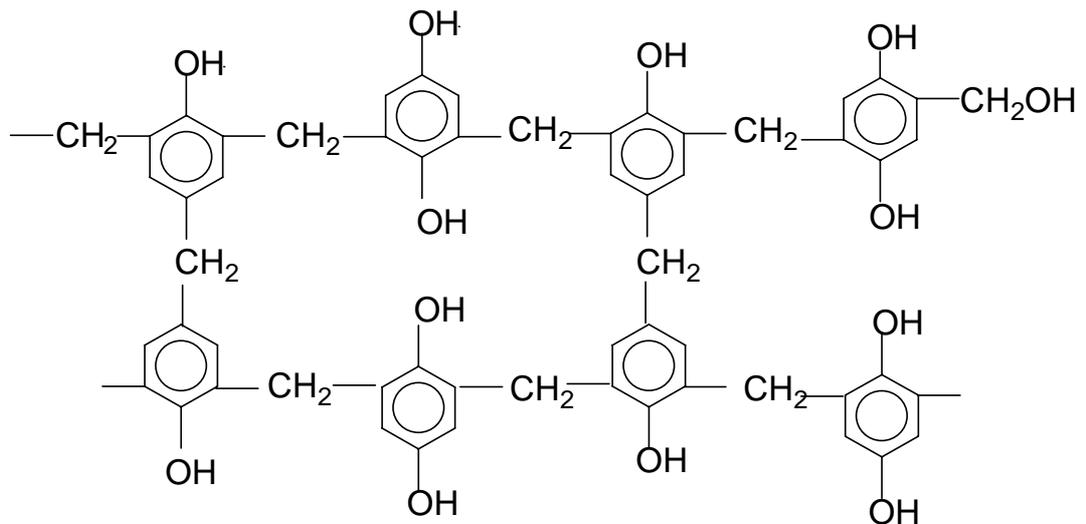
**Figura 2. Representação da estrutura de uma das primeiras resinas utilizadas em extração, resultante da policondensação de fenóis poliidrícos com formaldeído.**
