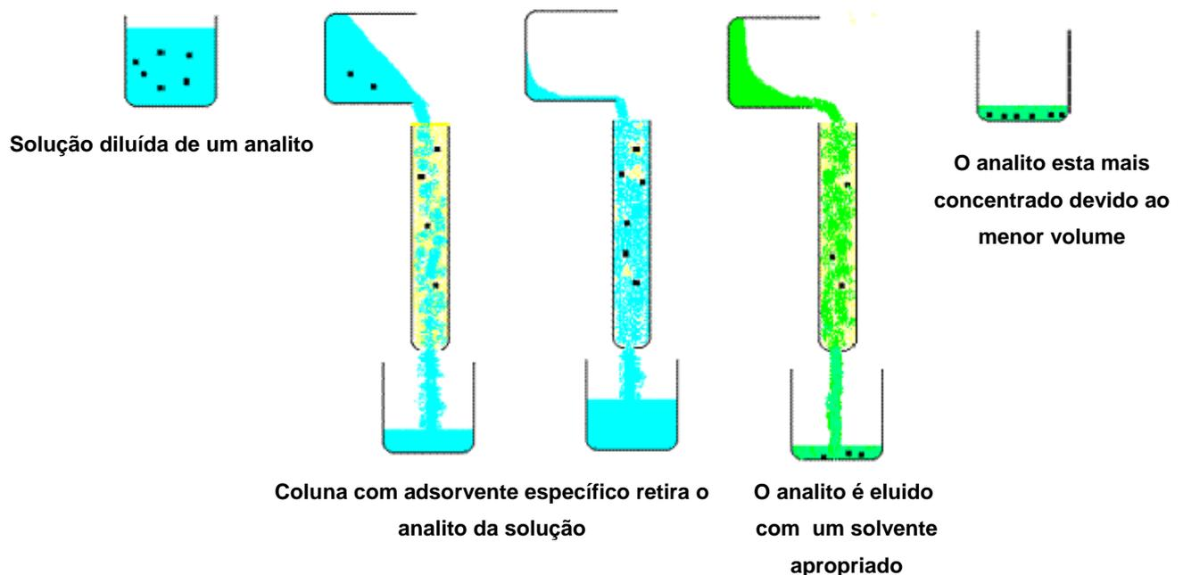
Figura 1. Esquema simplificado da pré-concentração de um elemento qualquer em uma coluna preenchida com material adsorvente.
