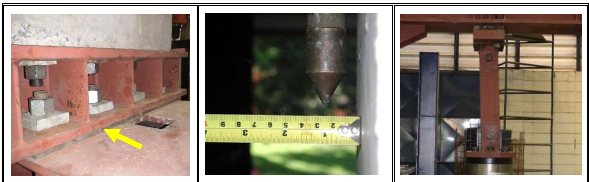
Figura 3.20 – Detalhe das chapas metálicas e desaprumo do modelo
