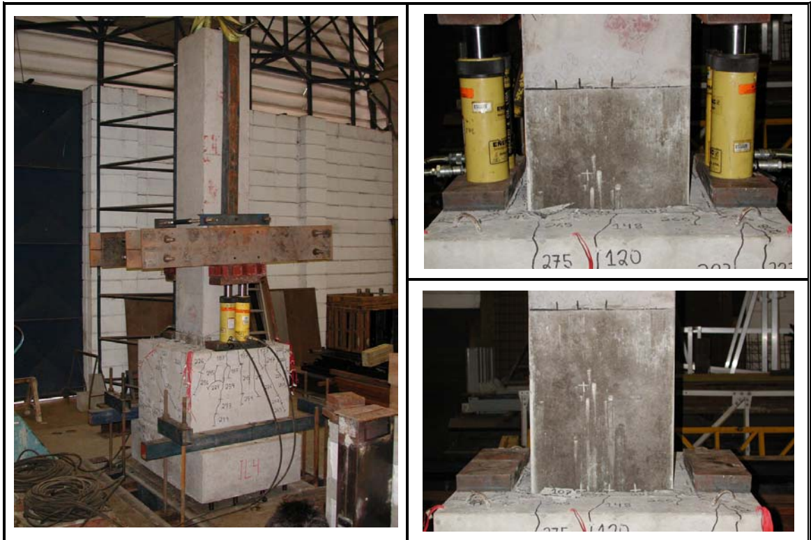
Figura 3.4 – Retirada dos pilares para aproveitamento dos cálices
