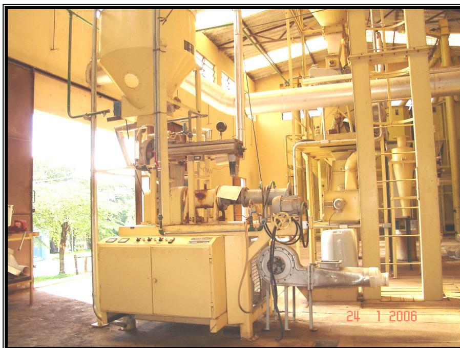
Figura 2. Extrusora utilizada na confecção dos concentrados experimentais.
