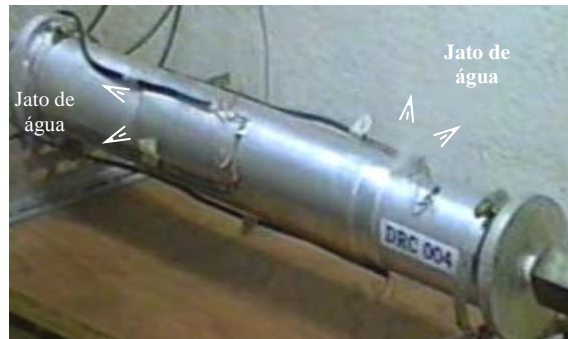
Figura 5.15 - Vazamento no espécime de duas camadas no reparo.
