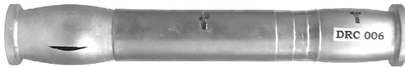
Figura 5.19 - Ruptura no espécime de quatro camadas no reparo.
