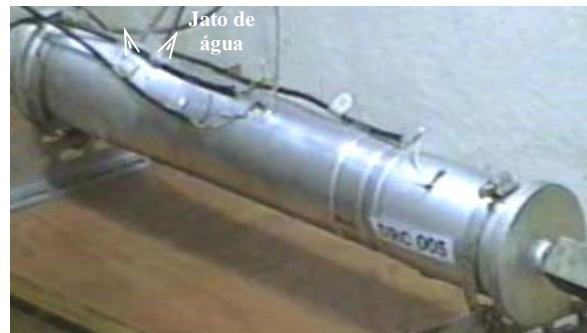
Figura 5.17 - Vazamento no espécime de três camadas no reparo.
