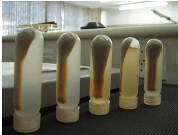
Figura 10 - Tubos com solo centrifugado em equipamento Jouan MR 1812
