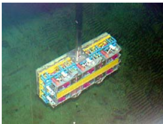
Figura 4.2.1.5: Modelo na escala 1:35 no ensaio de oscilação forçada, eixo Y.
