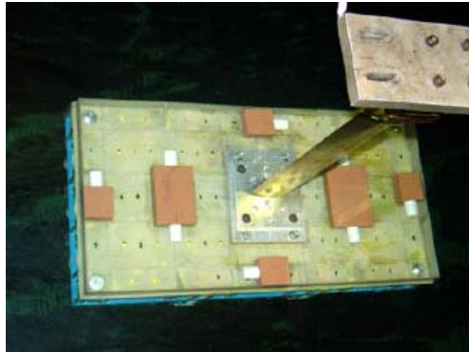
Figura 2.4.2.1.5: Modelo 1:35 durante ensaio de arrasto no eixo X.
