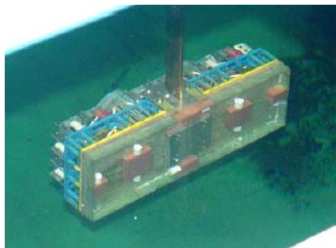
Figura 2.4.2.1.7: Modelo 1:35 durante ensaio de arrasto no eixo Z.
