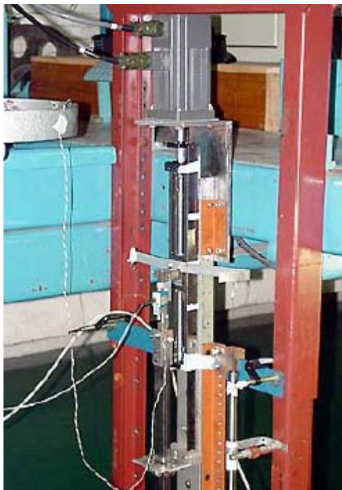
Figura 4.2.1.2: Aspecto do dispositivo de ensaio de oscilação forçada.
