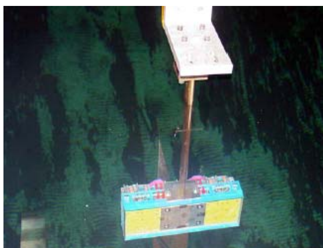
Figura 2.4.2.1.9: Aspecto do modelo 1:70 durante ensaio de arrasto no eixo Z.
