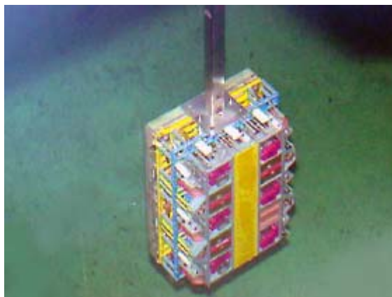
Figura 4.2.1.4: Modelo na escala 1:35 no ensaio de oscilação forçada, eixo X.
