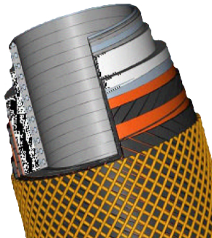
Figura 3 – Estrutura de um flexível com utilização de materiais compósitos na armadura de tração
