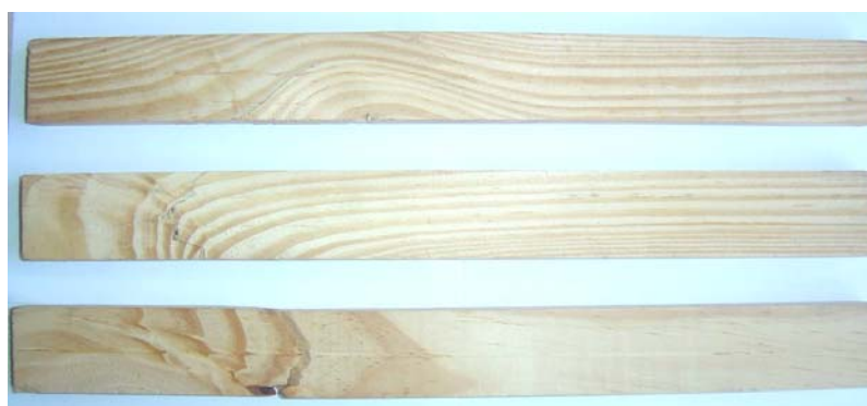
Figura 14 - Corpos-de-prova descartados em função da caracterização de desarranjo severo das fibras.
