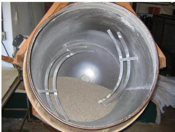
Figura 3. Betoneira com grãos de triticales adicionados de calcário e gesso.
