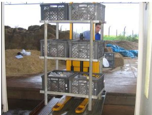
Figura 26. Entrada das estruturas de ferro com caixas de composto na câmara de incubação.
