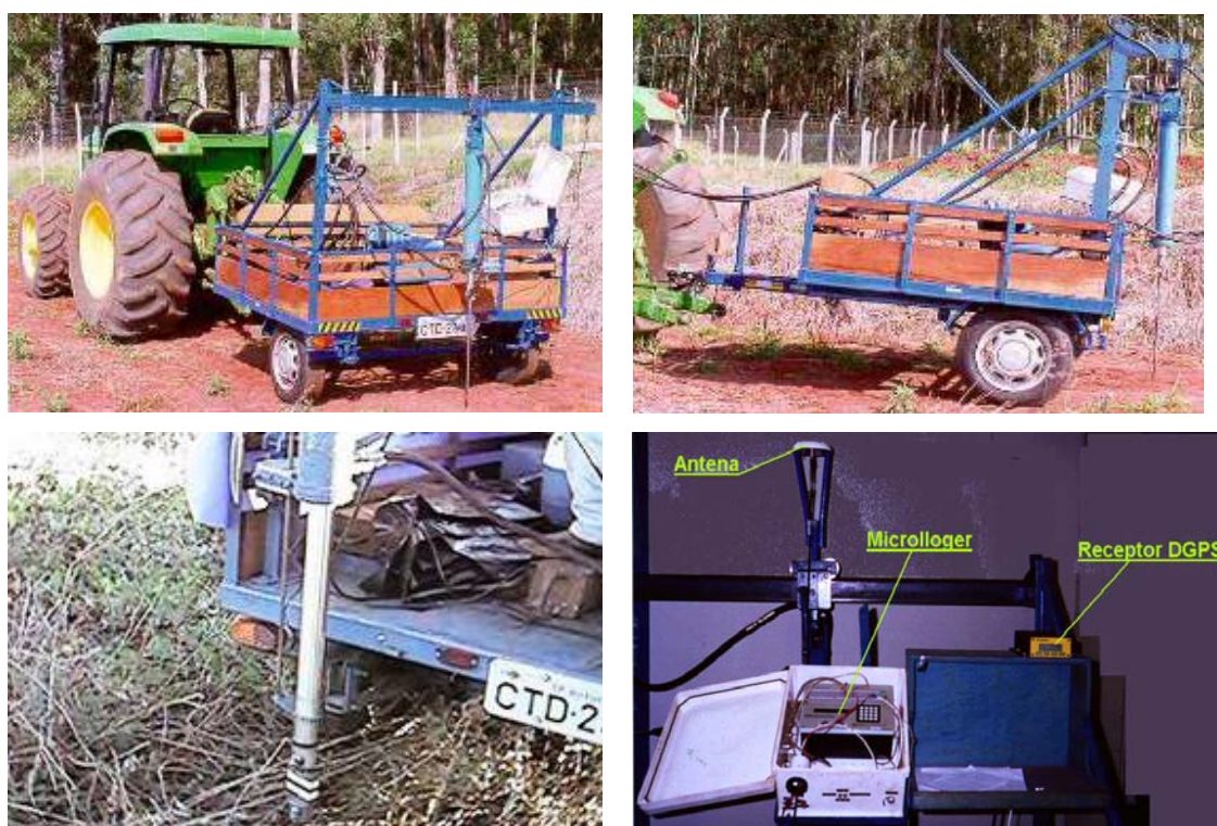
Figura 6. Vista do penetrômetro hidráulico eletrônico equipado com sistema DGPS e suas aplicações a campo.
