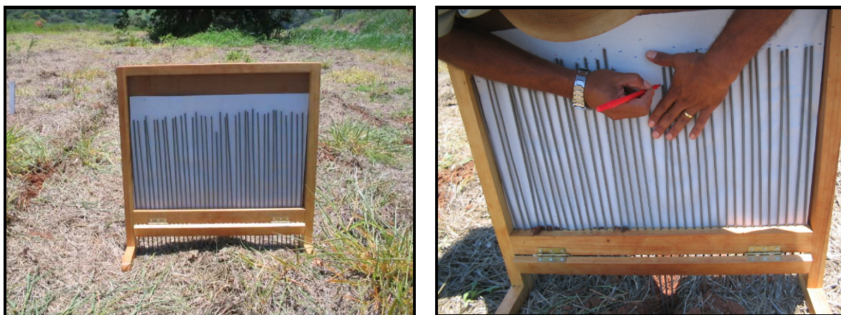
Figura 5. Perfilômetro utilizado para avaliar a área de solo mobilizado e a profundidade do sulco na linha de semeadura.
