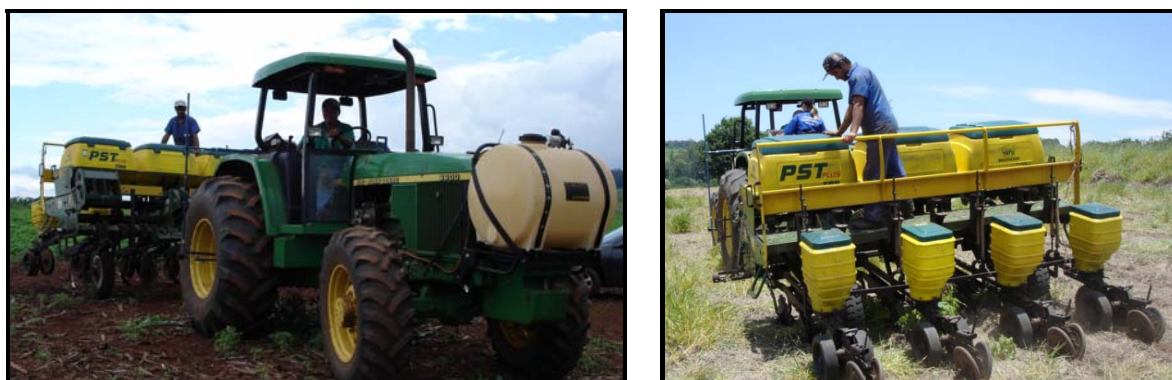
Figura 4. Conjunto trator-semeadora-adubadora utilizado na semeadura da cultura do milho.
