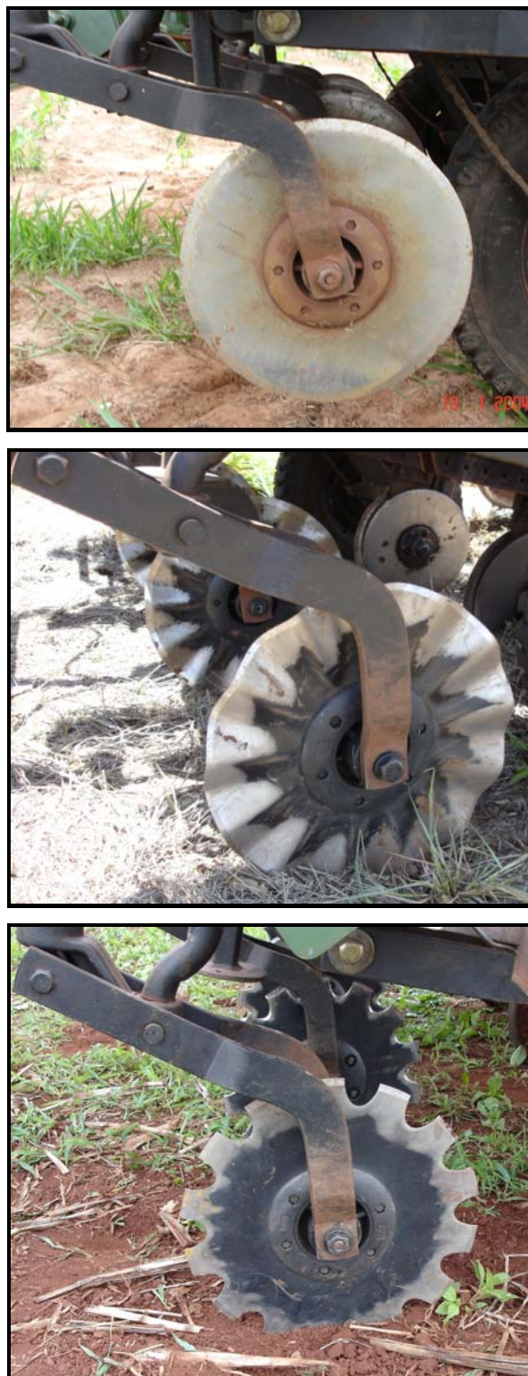
Figura 7. Discos de corte da vegetação utilizados na semeadura dos experimentos. Da figura superior à inferior, disco liso, disco ondulado e disco recortado.
