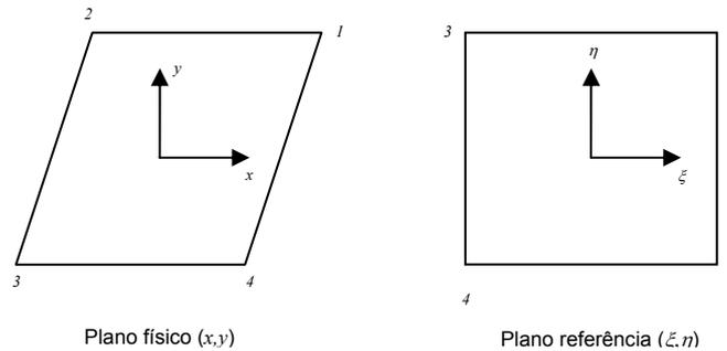
Figura 2.1: Elemento quadrilátero bi-linear. Plano físico e plano de referência.
