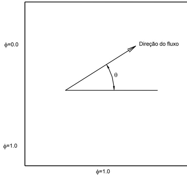
**Figura 4.1** Convecção através do domínio com condições de contorno homogêneas
