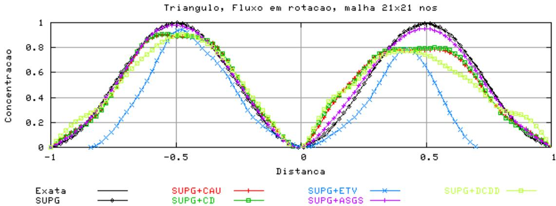
Figura 4.22 Fluxo rotacional, corte transversal.
