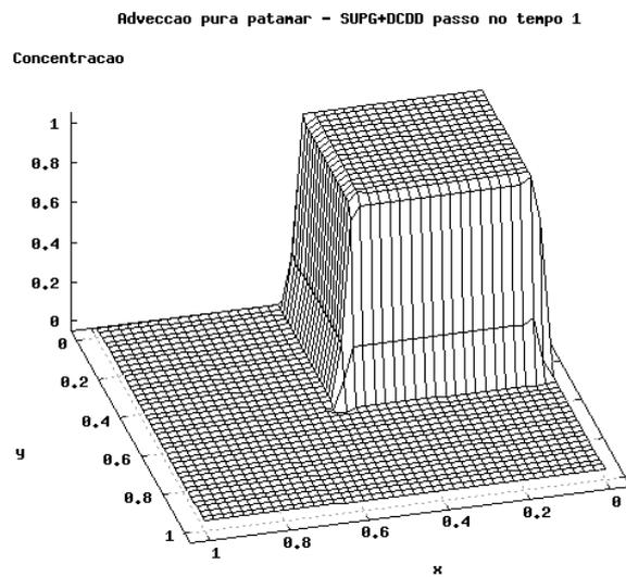
**Figura 4.25** Adveccão de um platô em um fluido em movimento unidirecional, elementos triangulares lineares, passo de tempo 1. (a) *SUPG*, (b) *SUPG+CAU*, (c) *SUPG+CD*, (d) *SUPG+ETV*, (e) *SUPG+ASGS*, (f) *SUPG+DCDD*.
