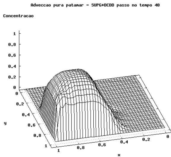
**Figura 4.27** Adveccão de um platô em um fluido em movimento unidirecional, elementos triangulares lineares, passo de tempo 40. (a) SUPG, (b) SUPG+CAU, (c) SUPG+CD, (d) SUPG+ETV, (e) SUPG+ASGS, (f) SUPG+DCDD.
