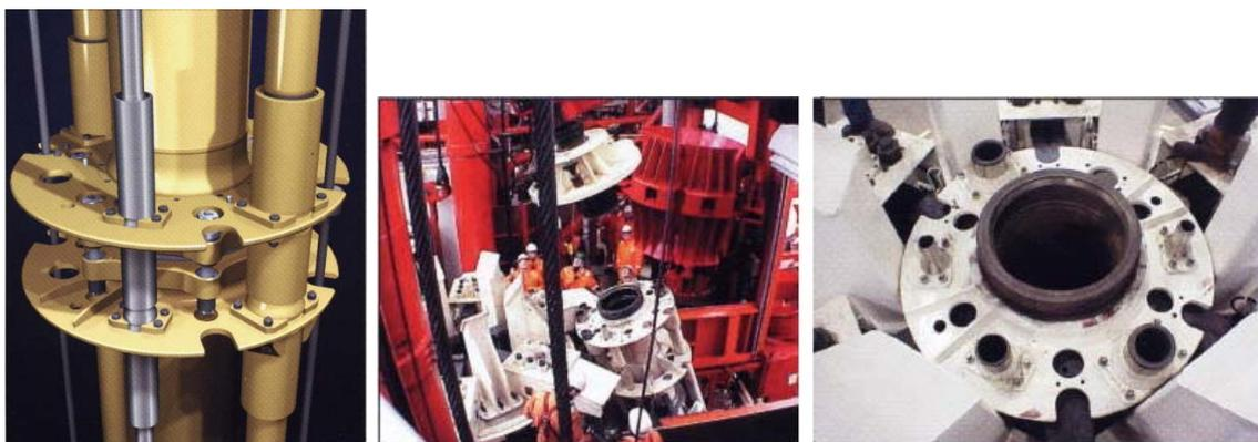
Figura 1.41 - Esquema e Foto da Conexão do Riser [24].
