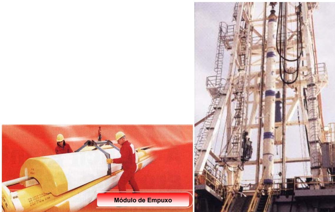
**Figura 1.44** - Módulos de Empuxo para *Riser* de Perfuração à Esquerda [25] e à Direita [24].
