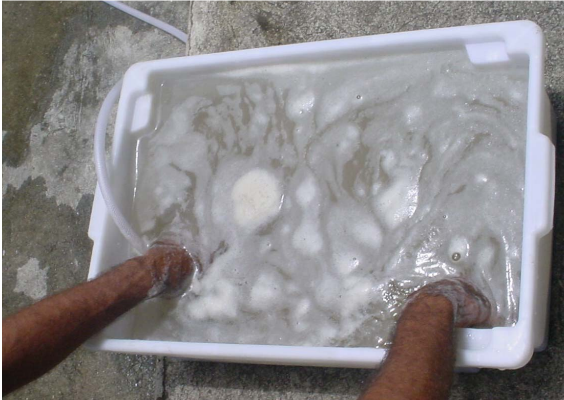
Figura 3.10- Lavagem da areia por meio de agitação manual com água corrente.
