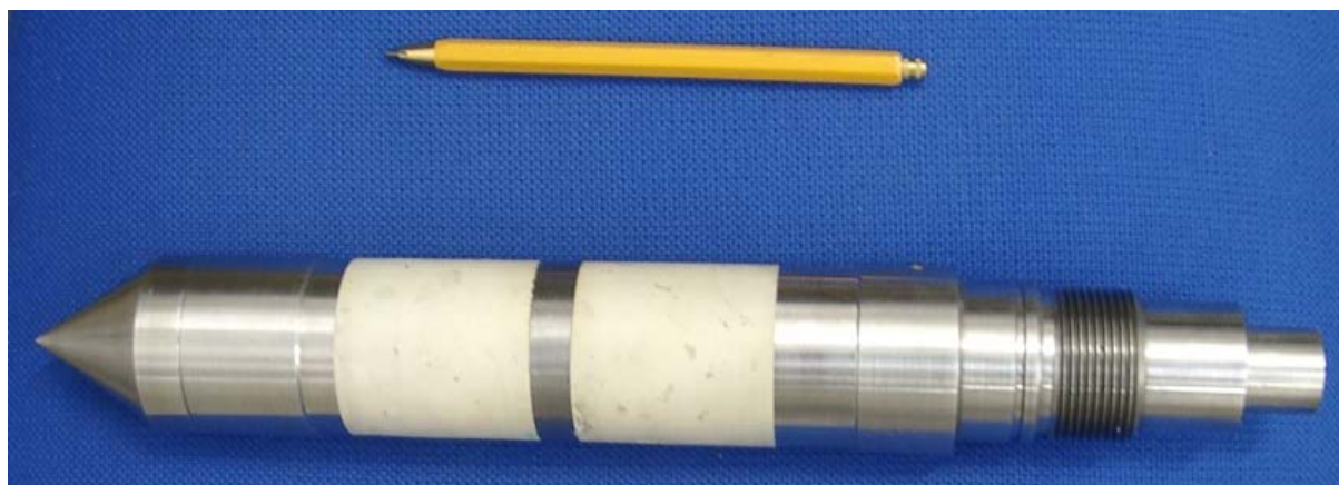
Figura 3.1- Fotografia do cone resistivo adquirido pelo programa PRONEX.
