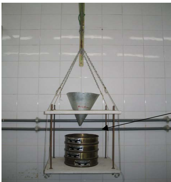
Figura 3.14- Conjunto de peneiras utilizadas no método adaptado para a elaboração de corpos de prova com a areia de Itaipuaçu e a misturada.
