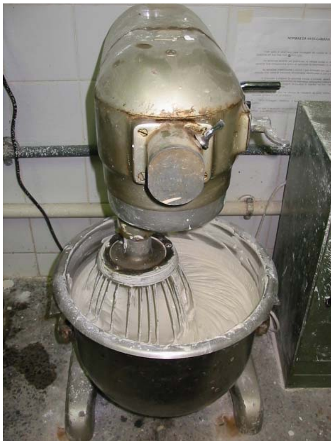
Figura 3.17- Batedeira industrial utilizada para homogeneizar os corpos de prova de caulim
