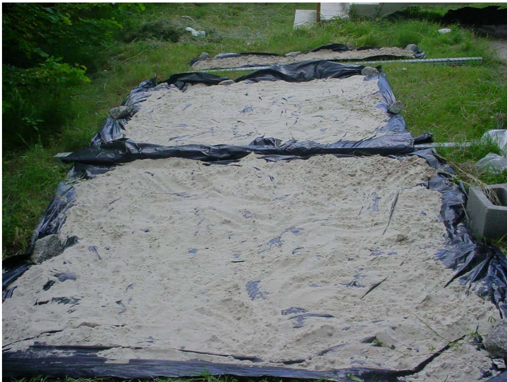
Figura 3.12- secagem ao ar da areia de são Francisco utilizada nos ensaios de resistividade.
