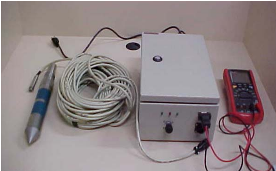
Figura 3.3- Conjunto de equipamentos necessários para medição de condutividade elétrica por meio do cone resistivo.
