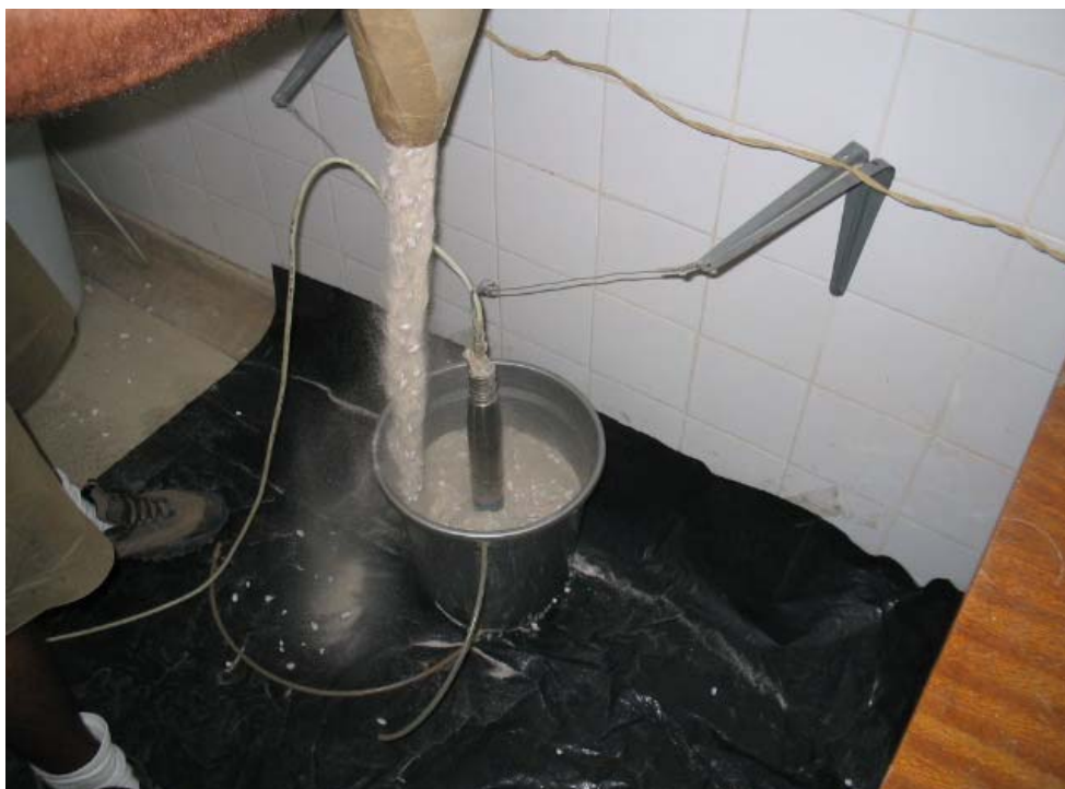
Figura 3.16- Método modificado de chuveiramento utilizando a areia de São Francisco misturada com conchas.
