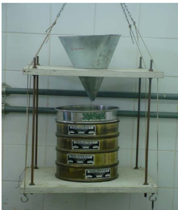
Figura 3.13- Conjunto de peneiras utilizadas para fazer os corpos de prova utilizando a areia de São Francisco, método original.
