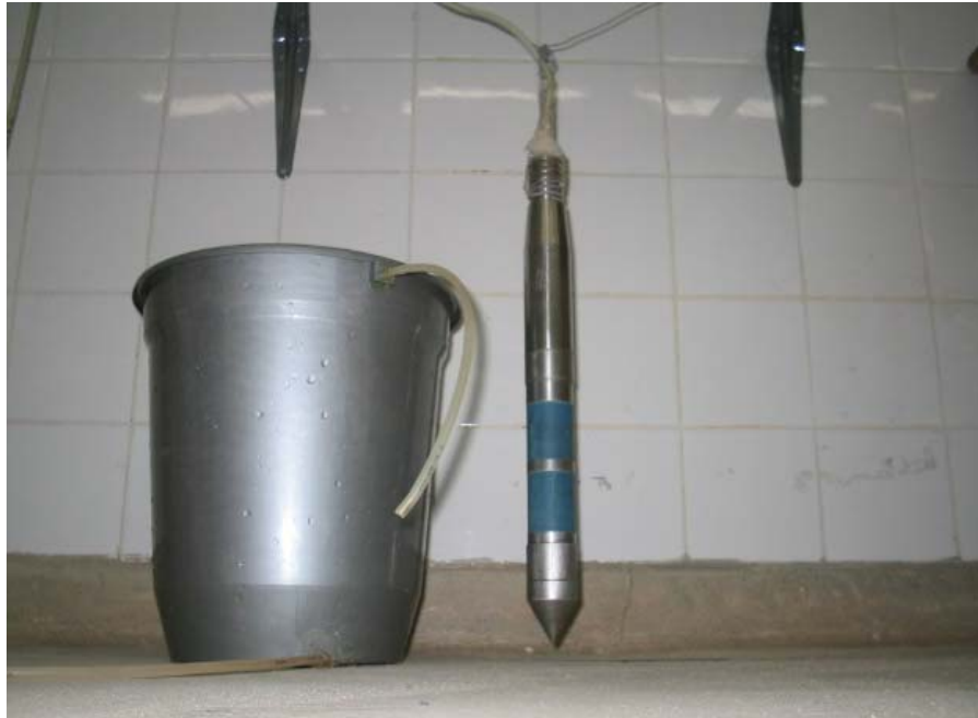
Figura 4.4- Comparação entre o cone resistivo e o balde utilizado nos ensaios.
