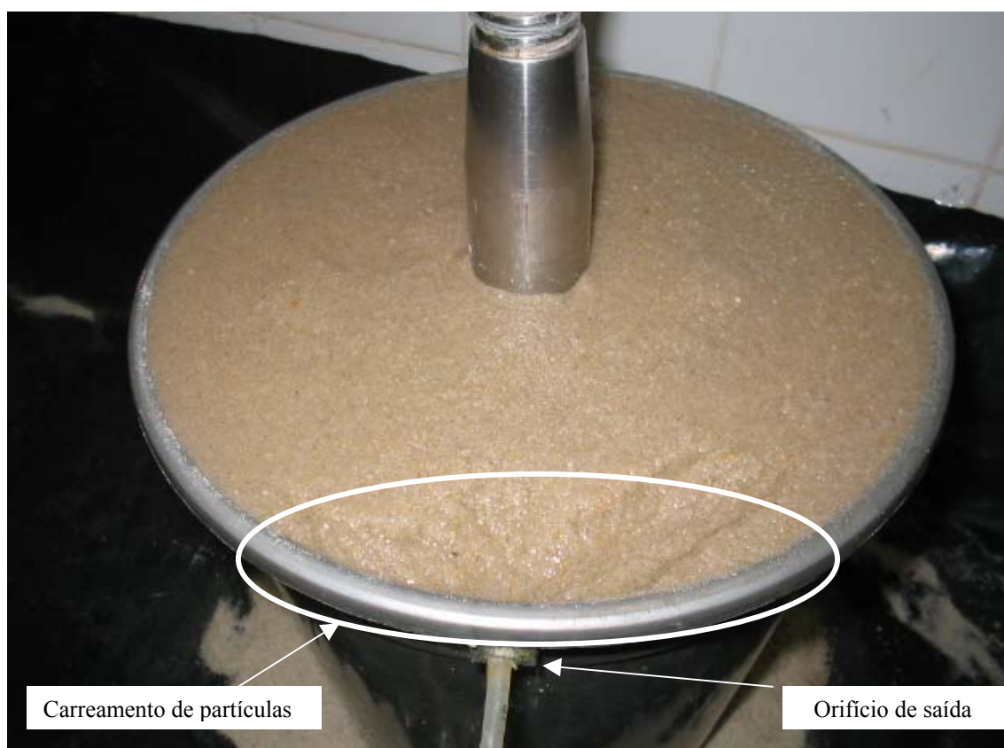
Figura 4.10- Balde utilizado no ensaio com areia submersa. No ponto de saída há perda de material, mas que ocorre em proporções pequenas e longe dos eletrodos do cone resistivo.
