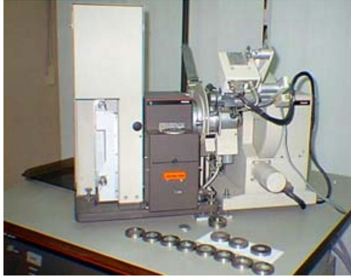
Figura 4.6 - Difratorômetro de Raios-X MPD 1880, Philips, para análise de estruturas cristalinas.
