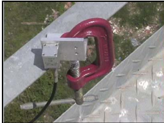
Figura VI.10 – Vista de acelerômetro instalado no topo da torre [1]
