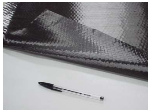
(c) Resina com Alta Concentração de Sólidos (d) Folha Unidirecional de Fibras de carbono
