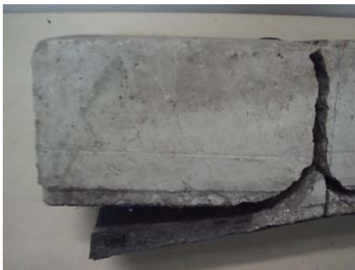
Meio do Vão Vigotas de Concreto Simples com 1 Camada de Reforço – VII-1-40 – f_{cm} = 50,0 MPa
