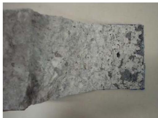
Meio do Vão Vigotas de Concreto Simples com 2 Camadas de Reforço – VI-2-40 – f_{cm} = 29,8 MPa
