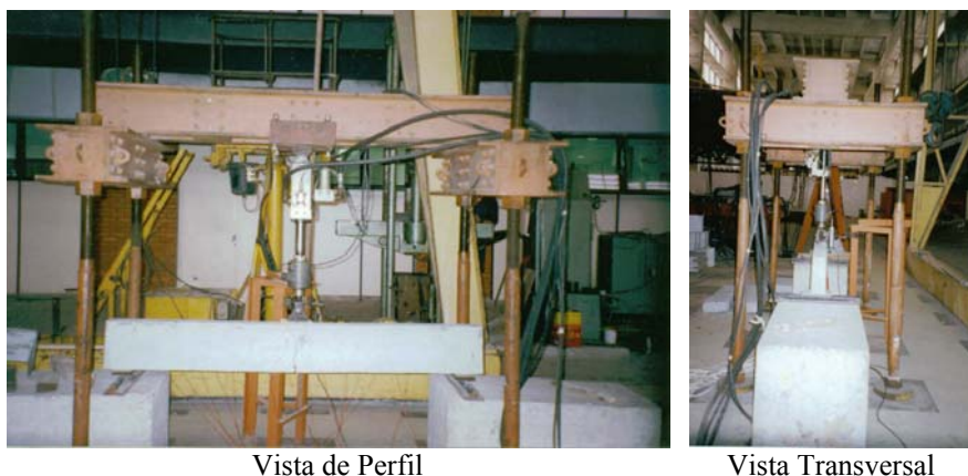
Figura 5.24 – Esquema de Ensaio das Vigotas de Concreto Armado
