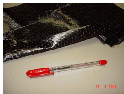
(a) Resina com Alta Concentração de Sólidos (b) Folha Unidirecional de Fibras de carbono
