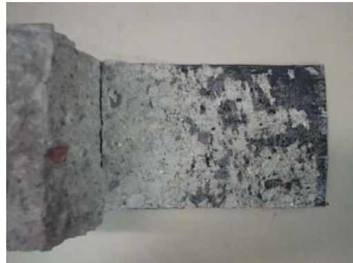
Meio do Vão Vigotas de Concreto Simples com 1 Camada de Reforço – VI-1-40 – f_{cm} = 29,8 MPa
