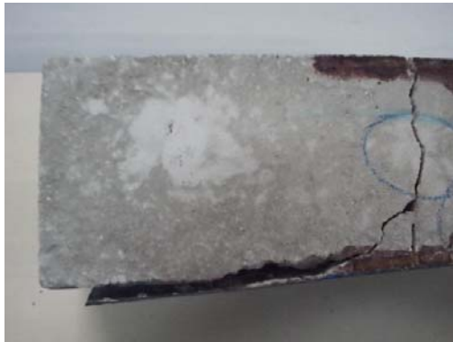
Meio do Vão Vigotas de Concreto Simples com 1 Camada de Reforço – VI-1-40 – f_{cm} = 29,8 MPa
