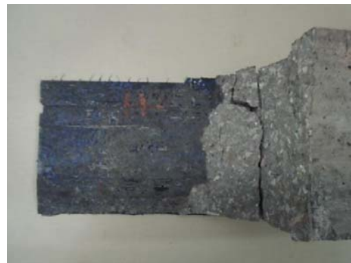
Meio do Vão Vigotas de Concreto Simples com 1 Camada de Reforço – VII-1-40 – f_{cm} = 50,0 MPa
