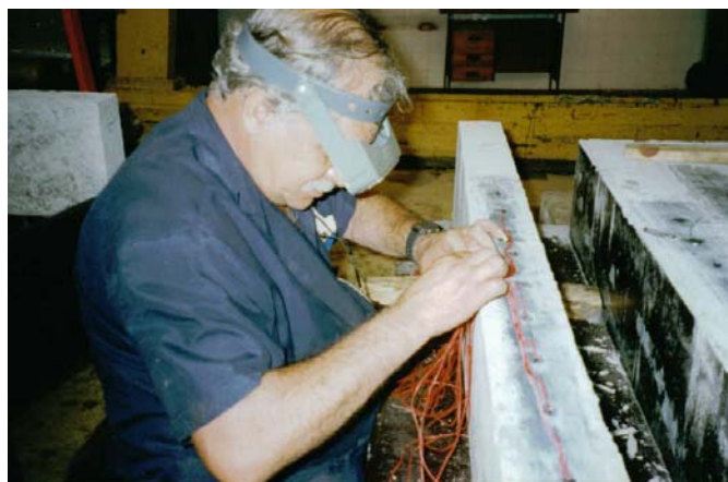
Figura 5.20 – Execução da Instrumentação das Vigotas de Concreto Armado
