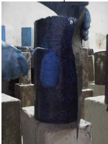
(f) Aplicação da resina sobre folha de fibras de carbono com rolo
