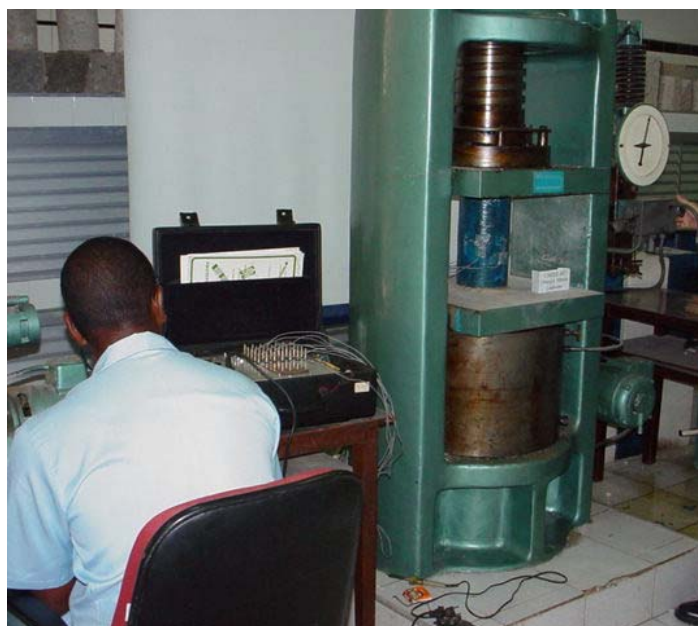
Figura 5.28 – Esquema de Ensaio de Compressão dos Pilaretes
