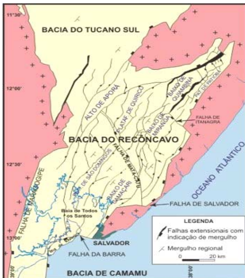
Figura 2.1: Localização, limites e arcabouço estrutural da bacia, no nível da seção pré-rift (modificado de SANTOS et al. , 1990).
