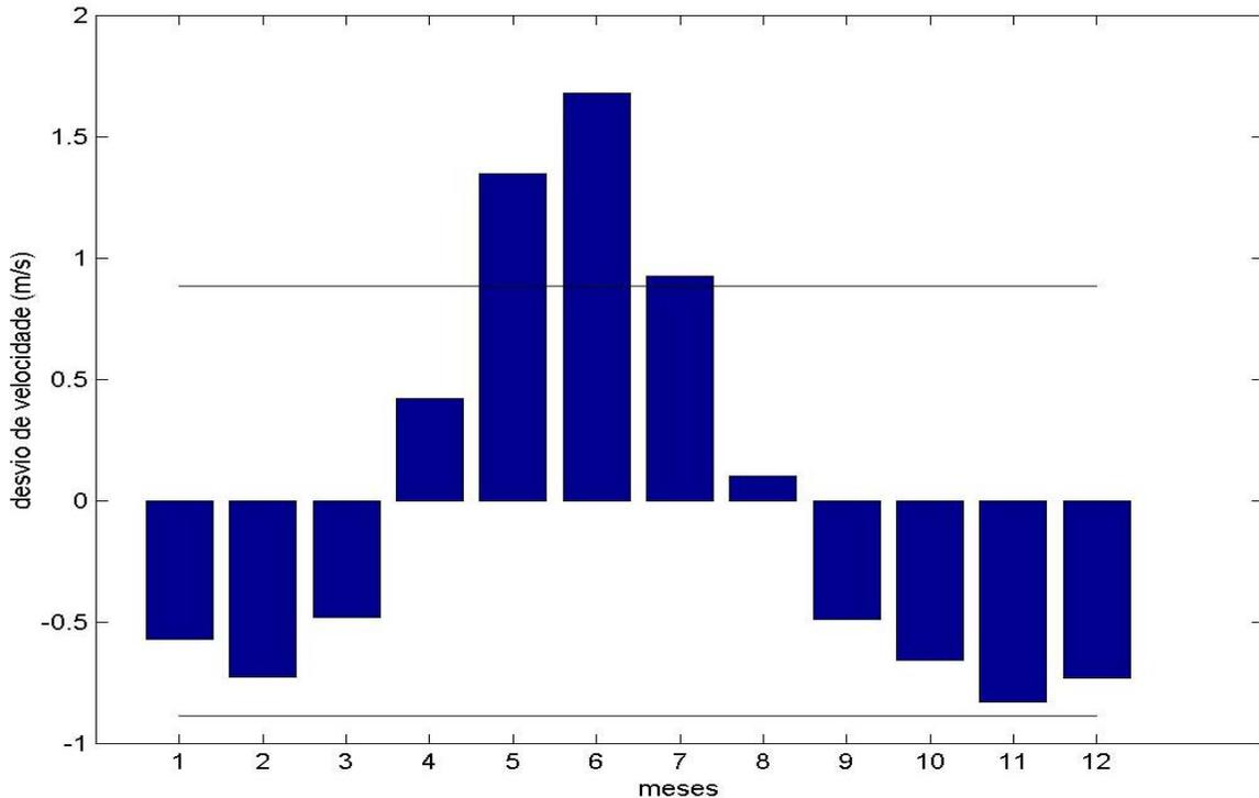
**Figura 3.2. Desvios mensais para o componente longitudinal da série de ventos no Chuí. Os valores positivos representam os ventos provenientes de quadrante sul e as medidas são realizadas de 01/1964 a 12/1999. A linha preta horizontal representa o desvio padrão da série.**
