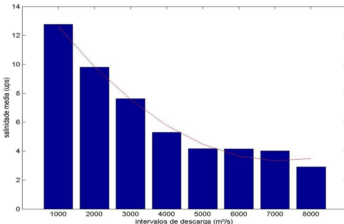
Figura 3.8. Relações entre valores selecionados de vazão em intervalos de  $1000 \text{ m}^3 \text{ s}^{-1}$  e salinidade média para o período de 1993 a 1999. A linha vermelha representa o melhor ajuste em segunda ordem para o histograma apresentado.
