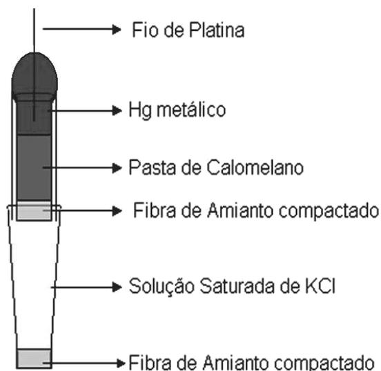
**Figura 3.1.2** – Eletrodo de Calomelano Saturado artesanal
