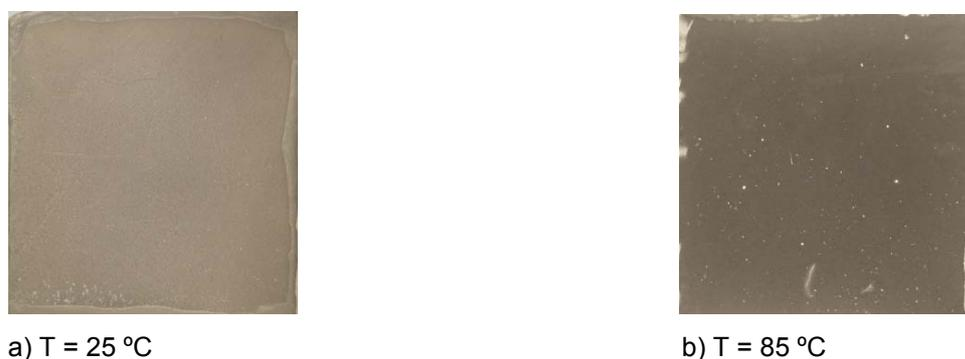
**Figura 6.1.2** – Fotos de amostra eletrodepositadas em SiNE,  $J = 0,3 \text{ mA/cm}^2$  e a diferentes temperaturas.
