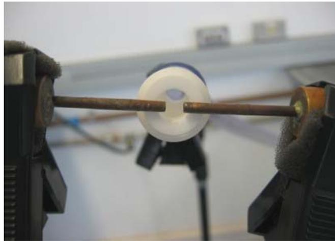
Figura 56 – Posicionamento das ponteiros para obtenção da  $H(f)$  de calibração.
