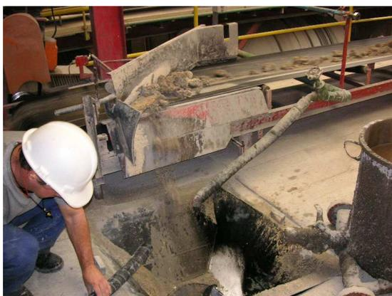
Depois do tempo necessário para a homogeneização, retirou-se uma amostra do moinho e foram realizados os testes de Resíduo, Densidade e Viscosidade. Estes testes são realizados para cada moinho separadamente.
