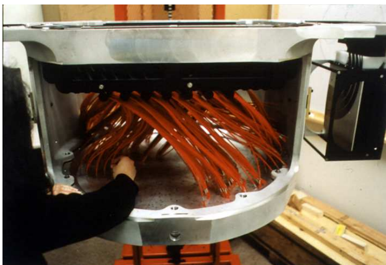
FIGURA 2.5 — Sistema de fibras ópticas utilizado pelo espectrógrafo do SDSS para a obtenção simultânea de espectros de centenas de objetos.
