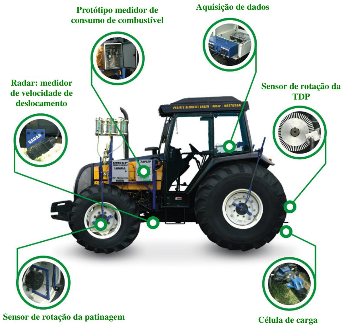
FIGURA 3. Vista geral do trator instrumentado. (Fonte: LOPES, 2006)
