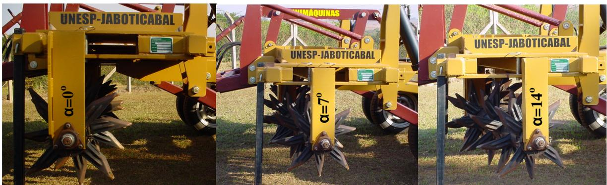
FIGURA 5. Aerossolo com o ângulo ( $\alpha$ ) das seções ( $0^\circ$ ;  $7^\circ$  e  $14^\circ$ ).
