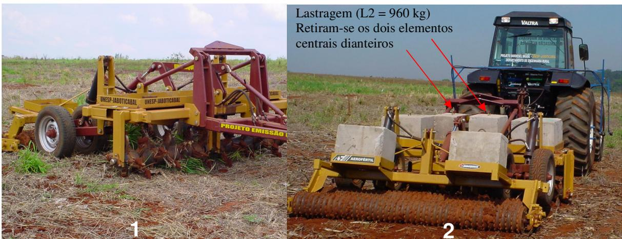
FIGURA 4. Aerossolo na condição sem lastro (1) e totalmente lastrado (2).
