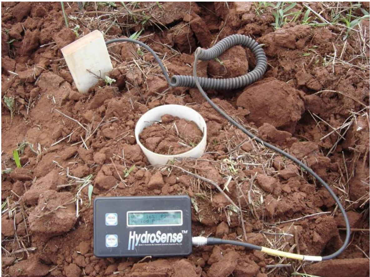
FIGURA 7. TDR - Hydrosense system, Sistema portátil utilizado para medição da umidade do solo e colar de PVC inserido no solo.
