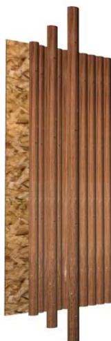
Figura 37 — Proposta 4.0 chapa OSB (1,22 X 1,22m) e \frac{1}{2} peças roliças (2,44m) cavilhadas
