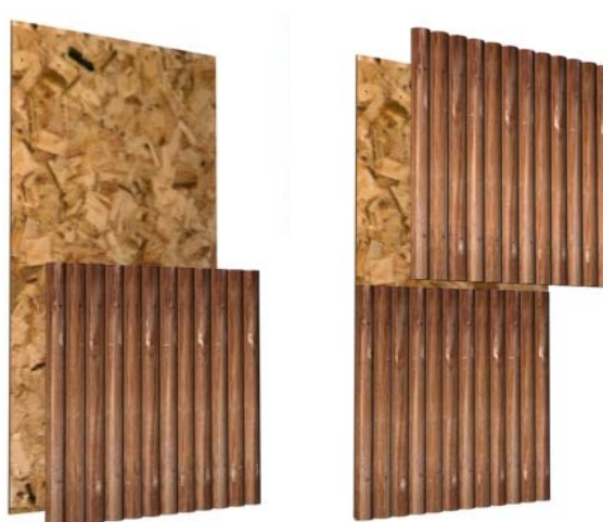
Figura 38 – Painel composto por chapas OSB e \frac{1}{2} peças roliças curtas de eucalipto através de pregação pneumática – Proposta 4.1
