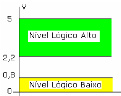
Figura 4 - Níveis lógicos dos Padrões TTL/CMOS convencionais.
