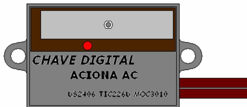
Figura 25 - Chave Digital ACIONA AC com DS2406, TIC226D, MOC3010.
