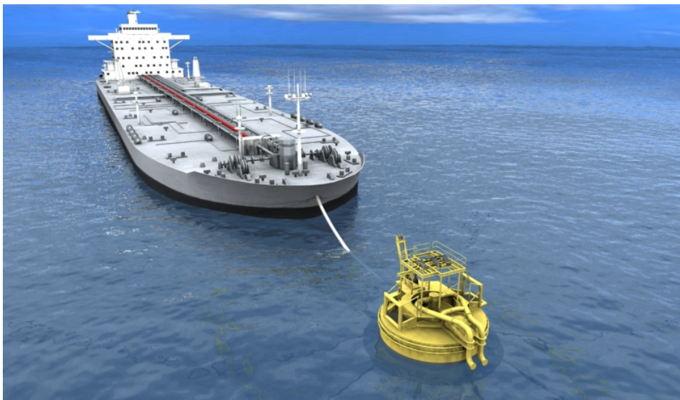
(b) Detalhe da operação de offloading
