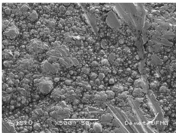
Figura 114 – Micrografia do eletrodepósito de níquel; DC = 5.0 \text{ A/dm}^2 ; aumento 500 x.
