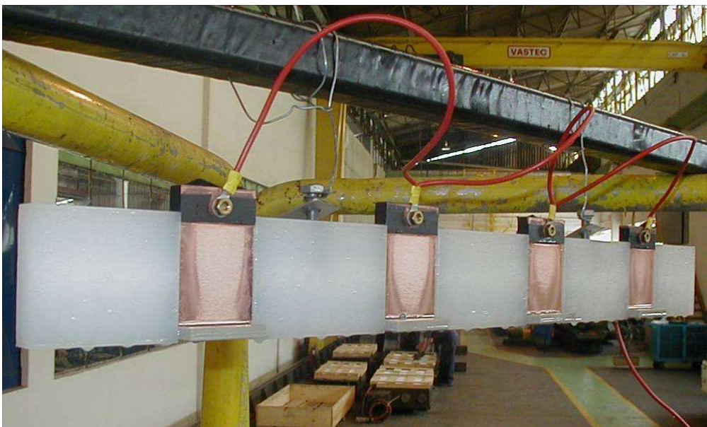
Figura 12 – Amostras montadas em dispositivo de polipropileno, prontas para decapagem.
