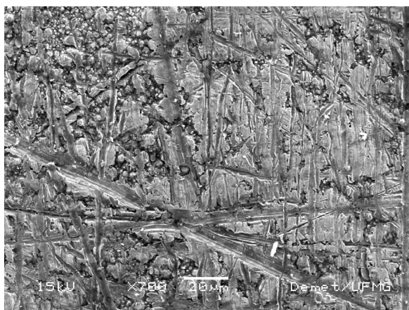
Figura 106 – Micrografia do eletrodepósito de níquel; DC =3.4 A/dm 2 ; aumento 700 x.
