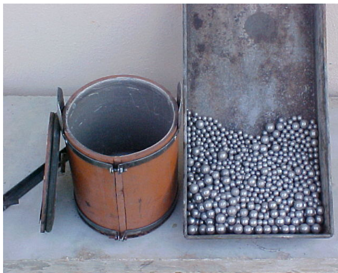
Figura 09. Cilindro e esferas utilizadas na moagem da CBC.
