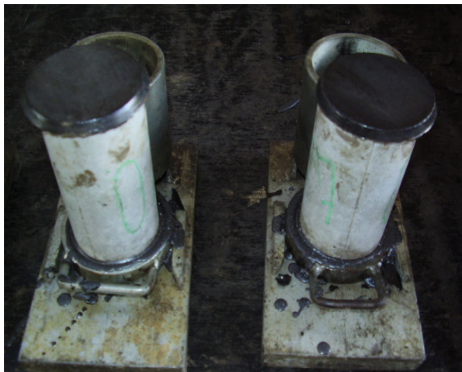
Figura 16. Capeamento dos corpos-de-prova.
