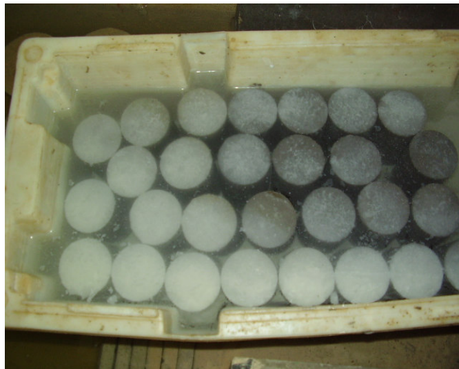
Figura 14. Corpos-de-prova submetidos à cura com cal.
