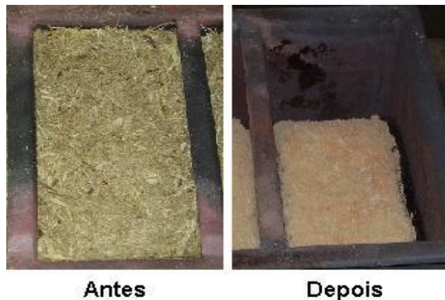
Figura 06. Bagaço da cana-de-açúcar antes a após a queima.
