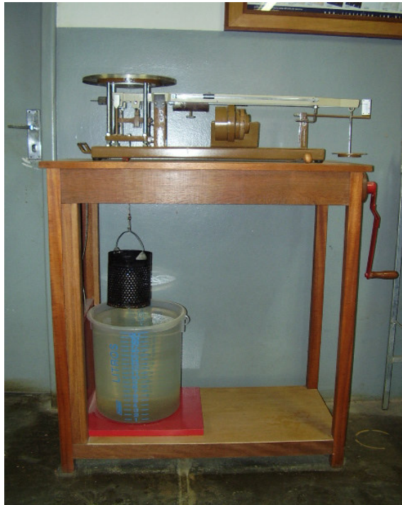
Figura 18. Ensaio de absorção de água por imersão, índice de vazios e massa específica.
