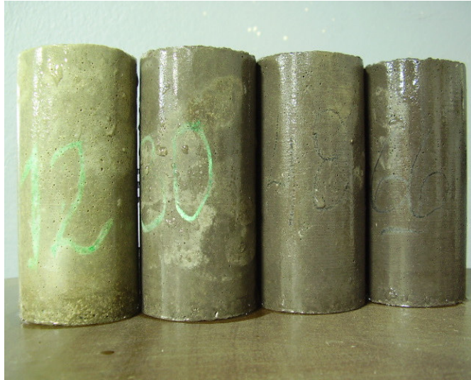
Figura 15. Corpos-de-prova com combinações C1, C2, C3, C4 de cimento-cinza de CBC.
