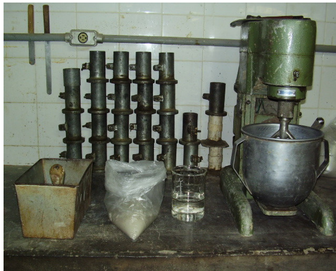
Figura 12. Moldagem dos corpos-de-prova.
