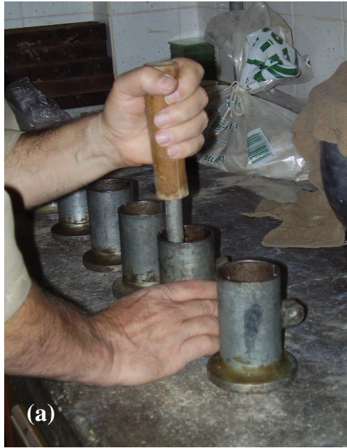
Figura 13. Adensamento(a) e Armazenamento(b) do corpo-de-prova.
