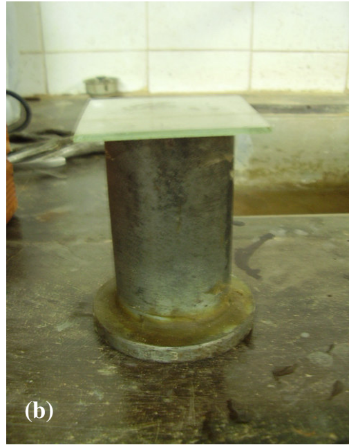
Figura 13. Adensamento(a) e Armazenamento(b) do corpo-de-prova.
