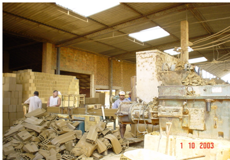
Foto II.25: Reaproveitamento junto ao mecanismo de corte
