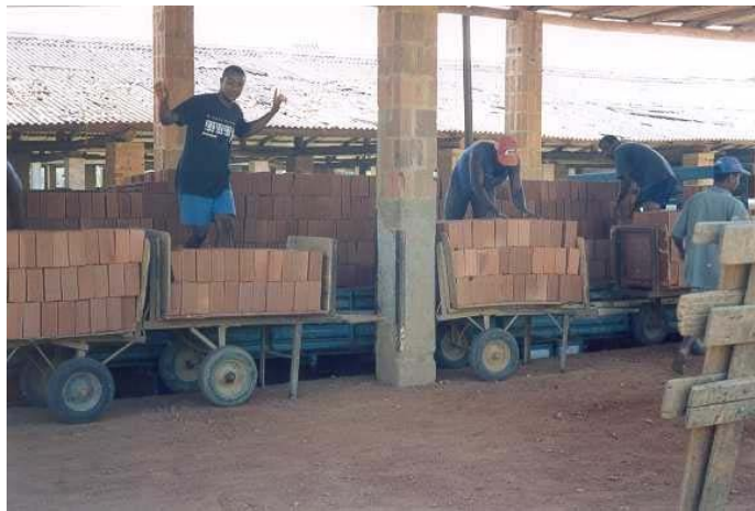
Foto II.34: Armazenagem e carregamento manual
