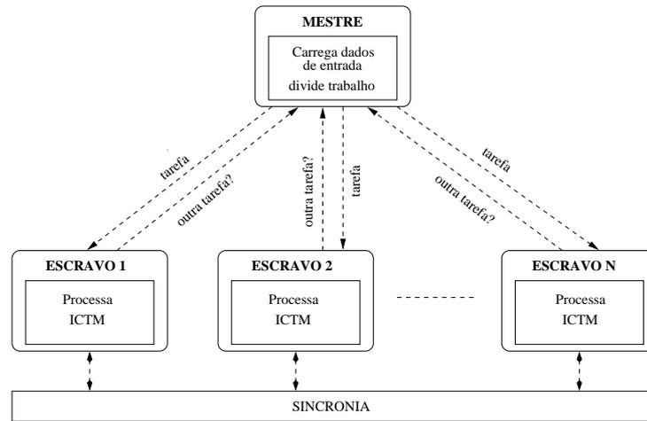
Figura 26 – Modelo paralelo do ICTM para máquinas agregadas: execução da forma de particionamento em domínios.
