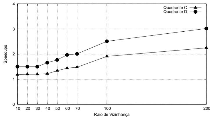
Figura 34 – Comportamento paralelo do ICTM para os quadrantes  $C_{(1309 \times 1765)}$  e  $D_{(1739 \times 2164)}$  com diferentes valores de raio nas máquinas P4.
